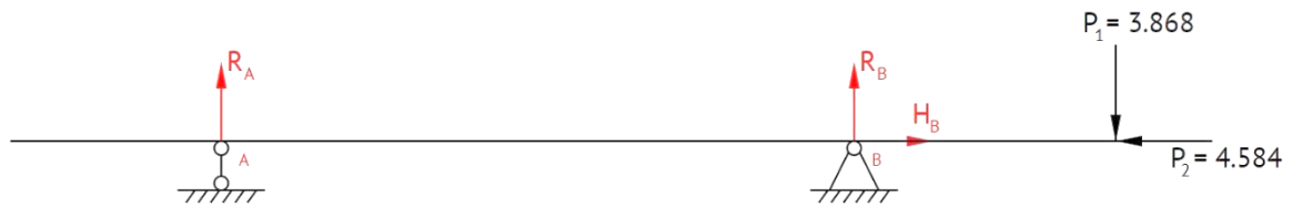
Figura 33. Diagrama de cargas para el plano horizontal del eje
