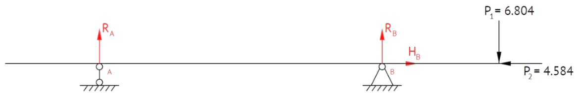
Figura 31. Diagrama de cargas para el plano vertical del eje
