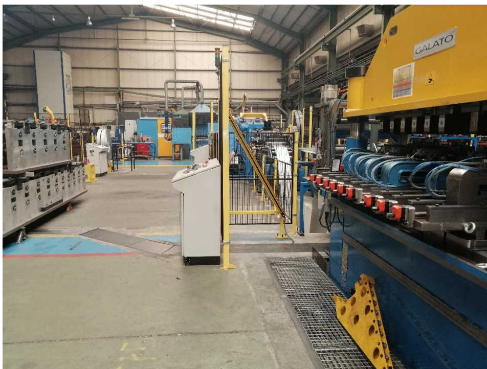
Imagen 5. Vista lateral de la zona de prensa en la que se puede observar la barrera fotoeléctrica.
