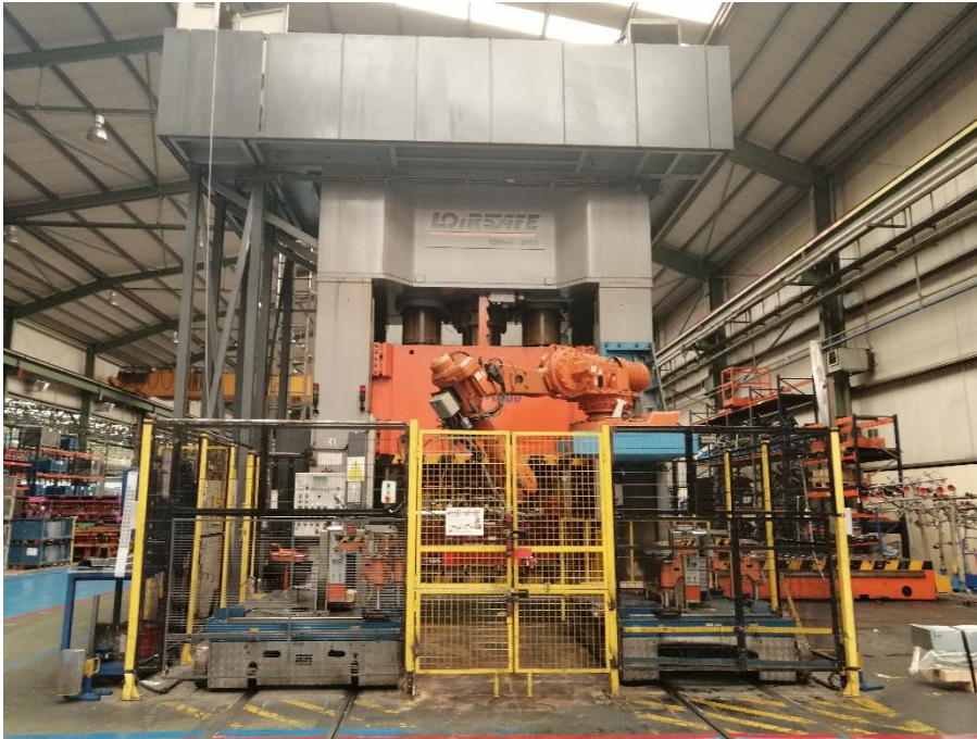
Imagen 16. Vista lateral de la Prensa 1500 Tn en la que se puede observar el robot y una de las puertas de seguridad.
