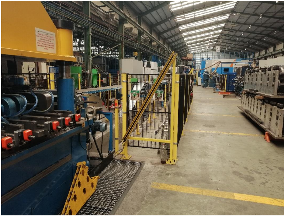
Imagen 6. Vista lateral de la zona de la prensa en la que se puede observar la barrera fotoeléctrica pareja de la imagen 5.
