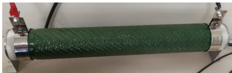
Figura 69. Resistencia de carga.
