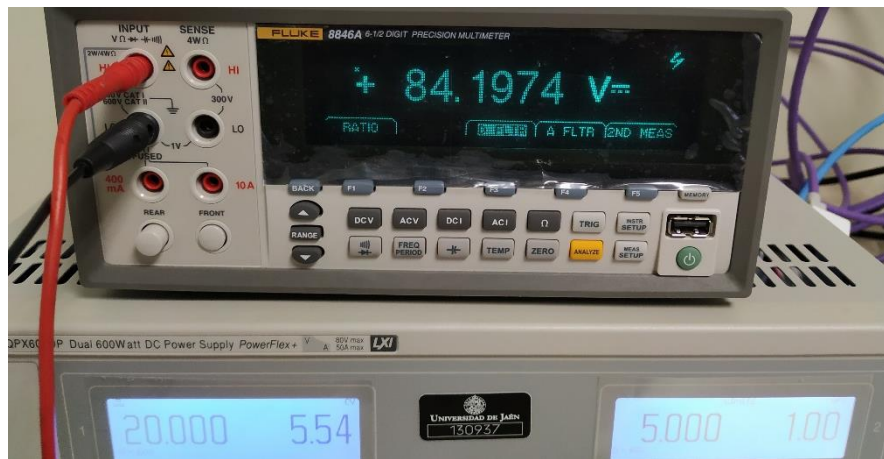
Figura 233. Multímetro y fuente de alimentación a 15 kHz y ciclo de trabajo a 20%.
