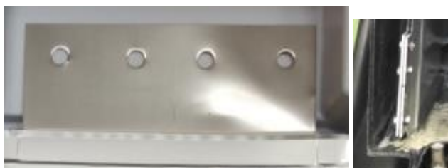
Figura 97: Bornes de las celdas de baterías. (Fuente TFM diseño de la instalación, evaluación de consumos y gestión de la energía de una motocicleta eléctrica).
