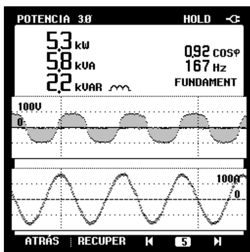
Figura 115: Resultados vatímetro y ondas de potencia medidas después del controlador. Ensayo3 (Fuente de elaboración propia).
