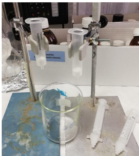
Figura 12. Montaje extracción en fase sólida.
