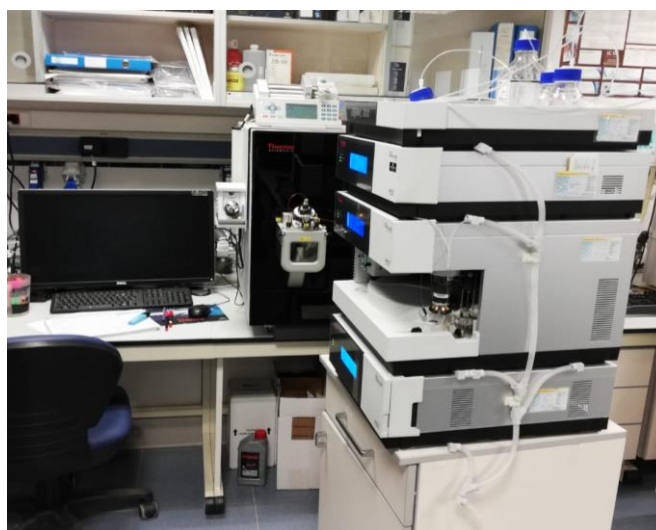
Figura 14. Cromatografía de líquidos/espectrometría de masas en tándem con un analizador triple cuadrupolo.
