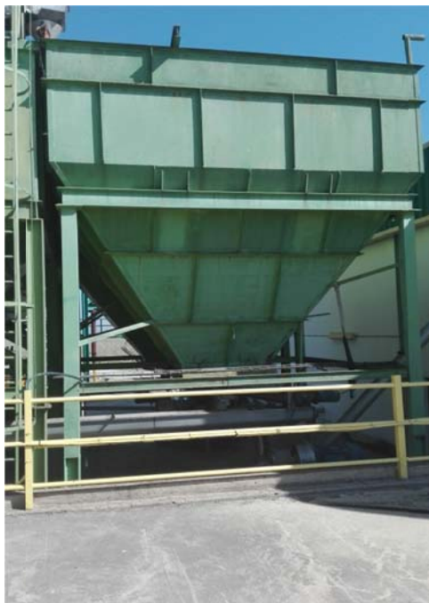
Figura A1.5. Tolvas de almacenamiento temporal de aceituna.
