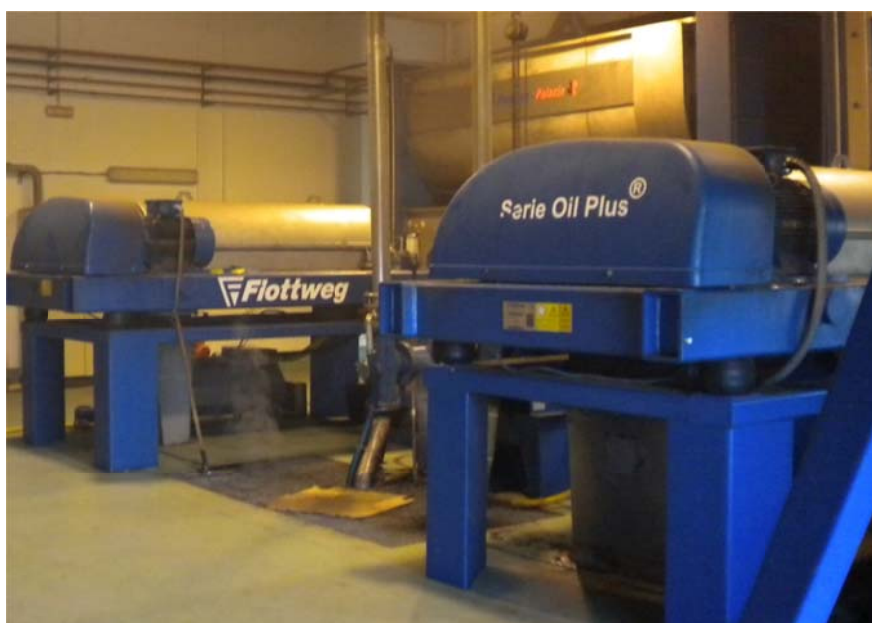
Figura A1.7. Decanters de aceite de oliva y batidora de pasta de aceituna
