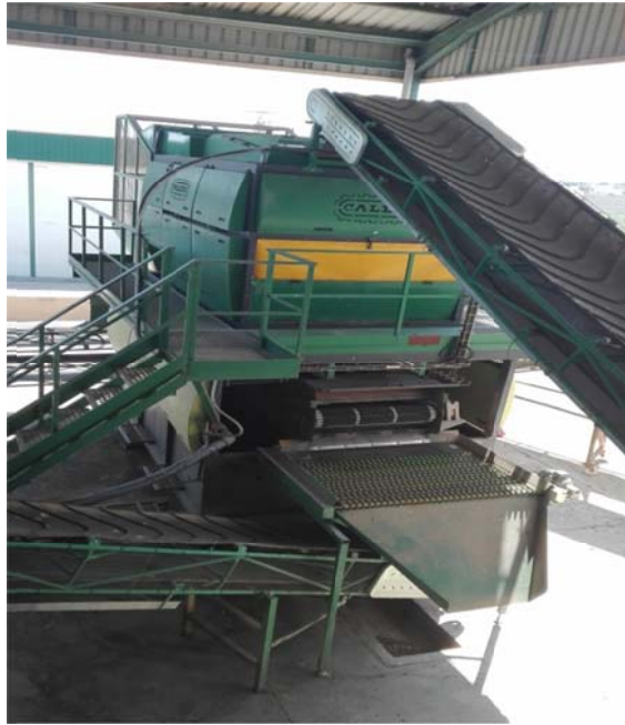
Figura A1.3. Máquina limpiadora de aceituna.
