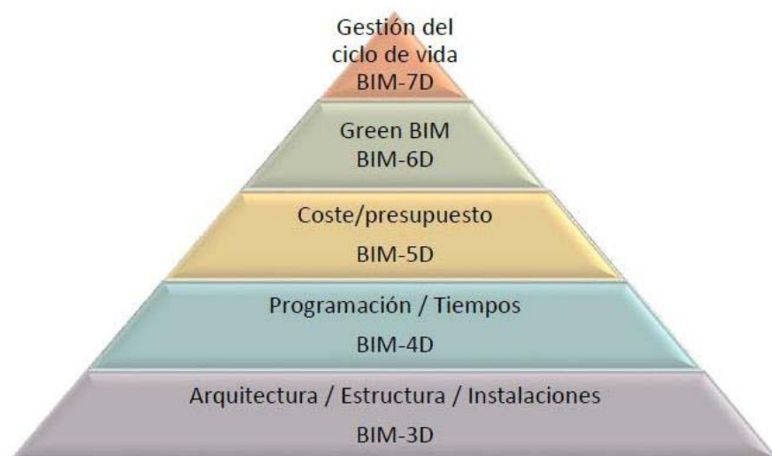
Imagen 5: Estructura piramidal que refleja los diferentes niveles de BIM.
