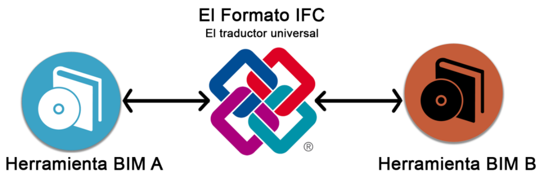
Imagen 7: Esquema de transformación entre archivos del entorno BIM.
