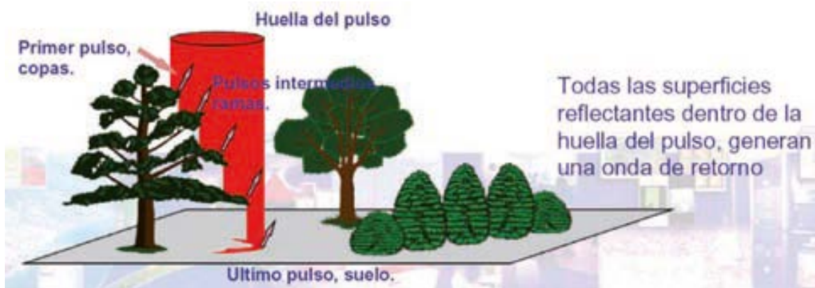
Ilustración 2.1.- Toma de datos del LiDAR. Fuente: INCLAM
