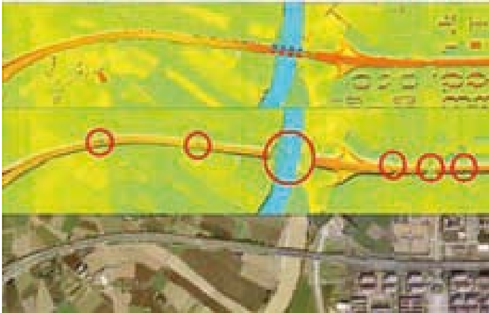
Ilustración 2.7.- Detección y eliminación de puentes, pasos elevados y obras de drenaje. Fuente (INCLAM)
