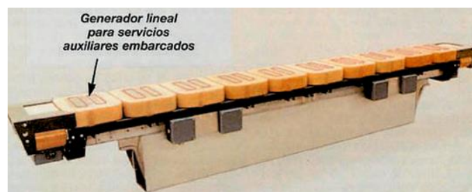
Ilustración 5.22.- Motor lineal utilizado en la tracción de los trenes maglev
