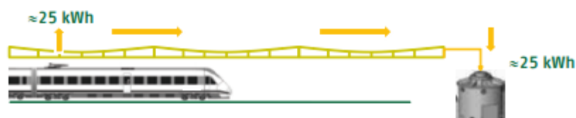
Ilustración 8.2.- Etapa de carga en el proyecto de las Ferrolineras
