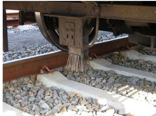
Ilustración 7.6.- Colector de escobillas del sistema CROCODILE
