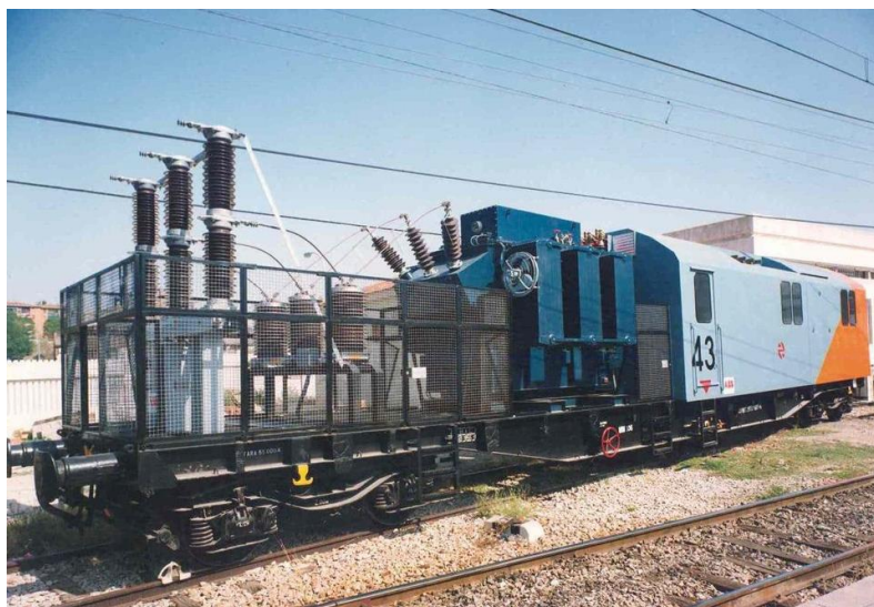
Ilustración 4.13.- Modelo antiguo de una subestación de tracción móvil
