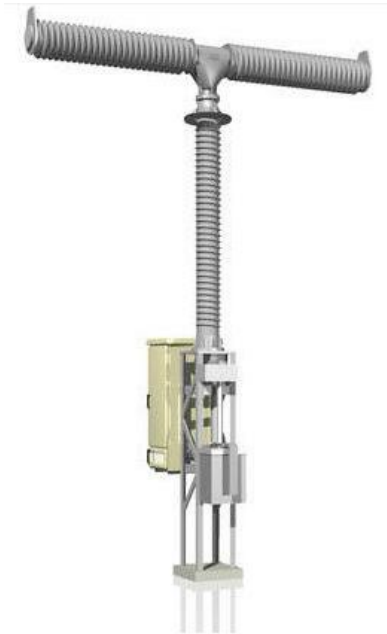
Ilustración 4.34.- Interruptor automático de protección de línea y del transformador de potencia
