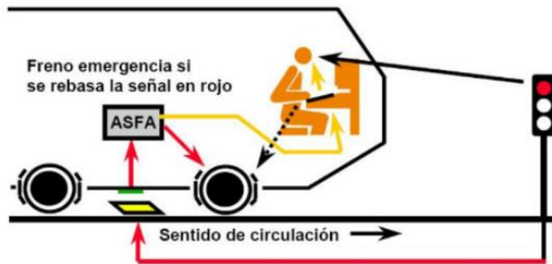
Ilustración 7.3.- Esquema general de actuación del sistema ASFA
