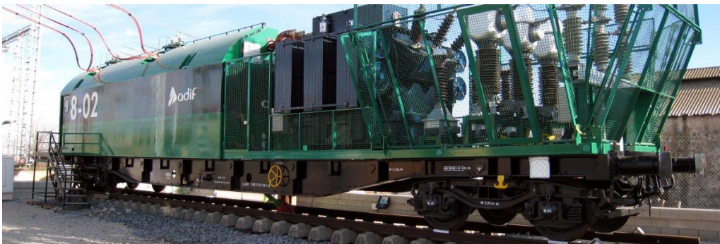
Ilustración 4.12.- Subestación de tracción móvil
