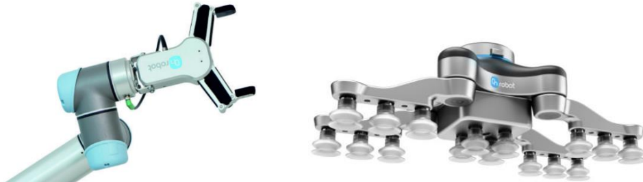
Figura 4: Pinza por accionamiento eléctrico (izquierda) y elemento final de ventosa (derecha)
