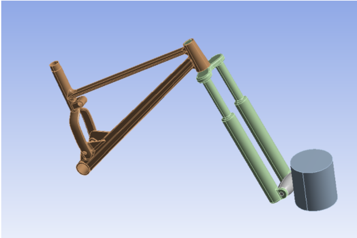
Figura 4.37. Montaje del ensayo de choque por caída de masa.
