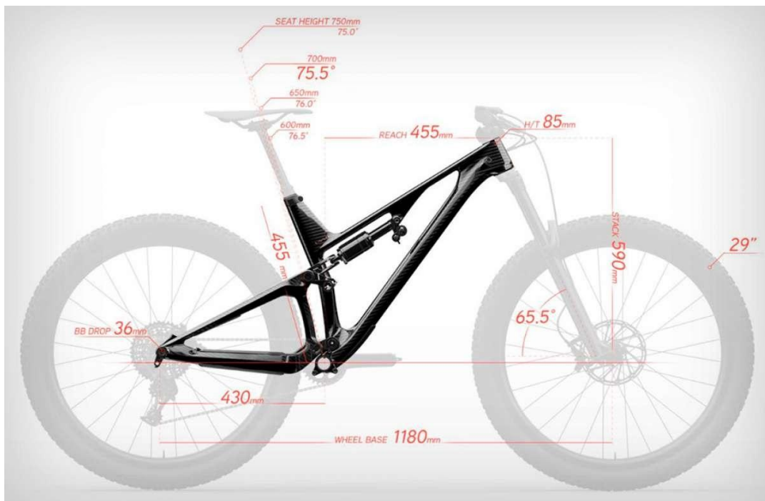
Figura 1.6. Geometría de una bici de montaña de doble suspensión. [6]
