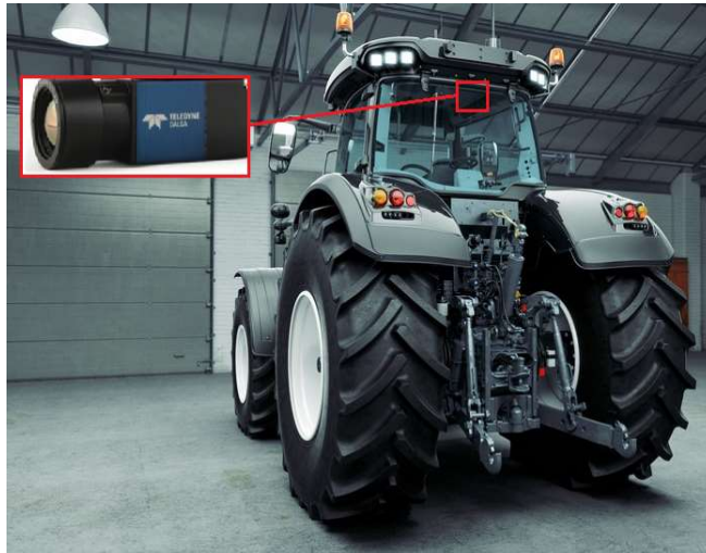
Ilustración 26 Posicionamiento de cámara infrarroja trasera
