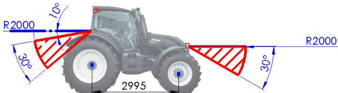
Ilustración 40 Vista Perfil de cobertura de sensores ultrasonidos HC-SR04
