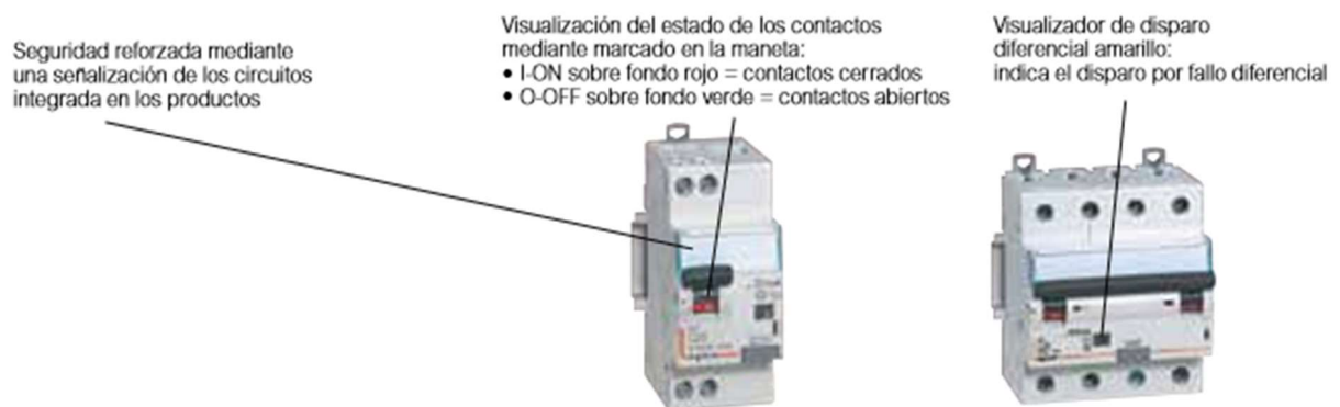
Ilustración 19 Interruptor magnetotérmico diferencial monoblock DX 6000 [3]
