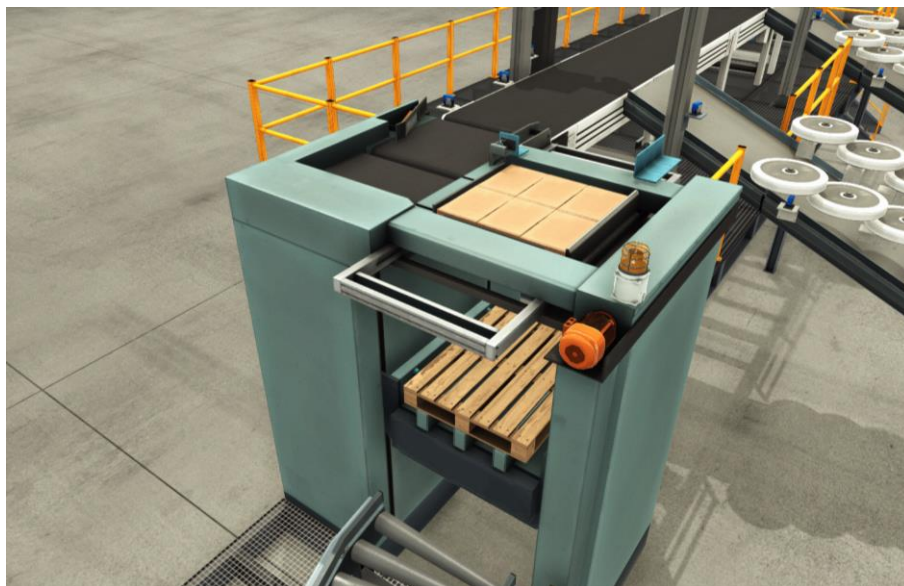
Figura 48. Elevador con cajas pequeñas
