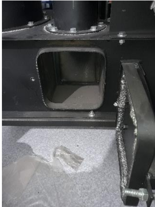
Figura 4.16 Interior depósito cenizas del ciclón.
