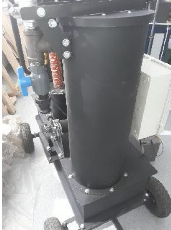
Figura 4.19 Refrigerador o condensador
