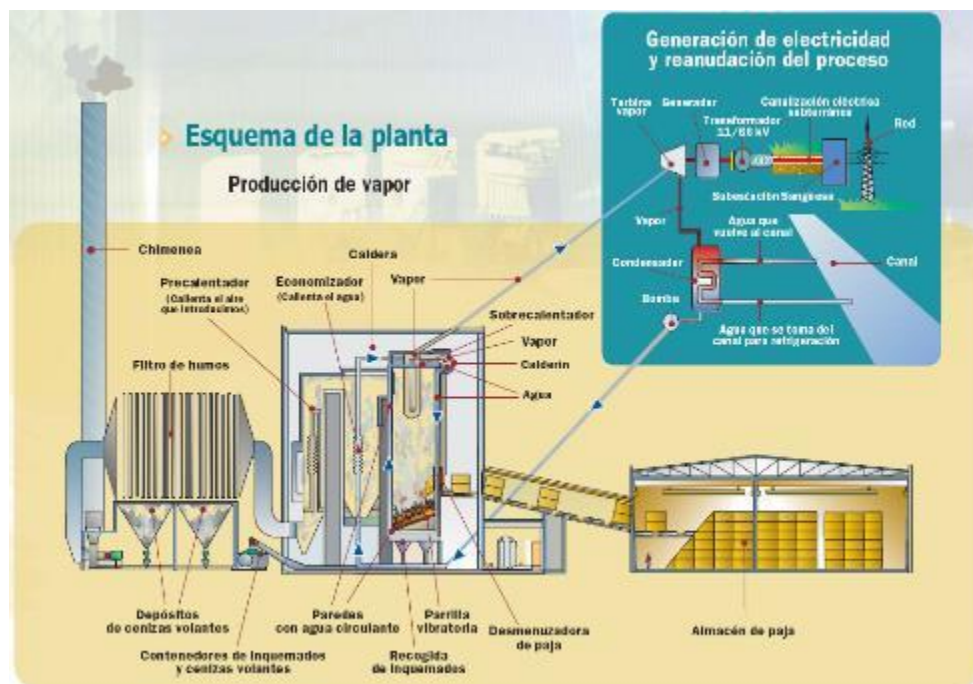
Figura 2.15 Esquema de la planta Sangüesa, Navarra. Fuente: https://venzario.com/2009/03/07/plantas-de-biomasa-sanguesa/ .
