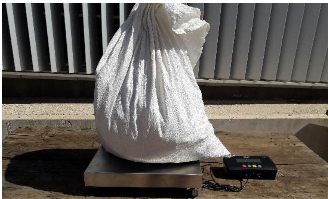
Figura 5.2 Pesada astillas poda olivar
