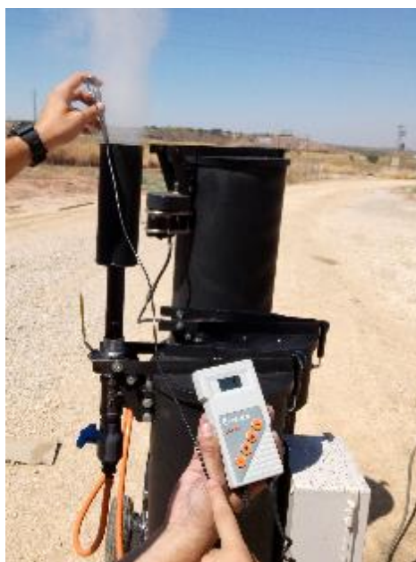
Figura 5.13 Medida de la temperatura de los gases
