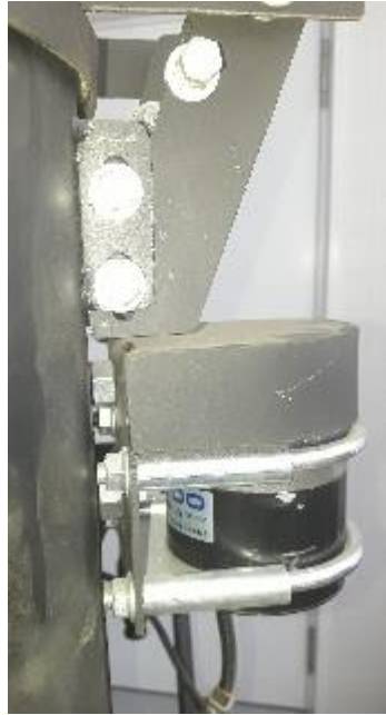
Figura 4.14 Motor para agitar biomasa Hopper.
