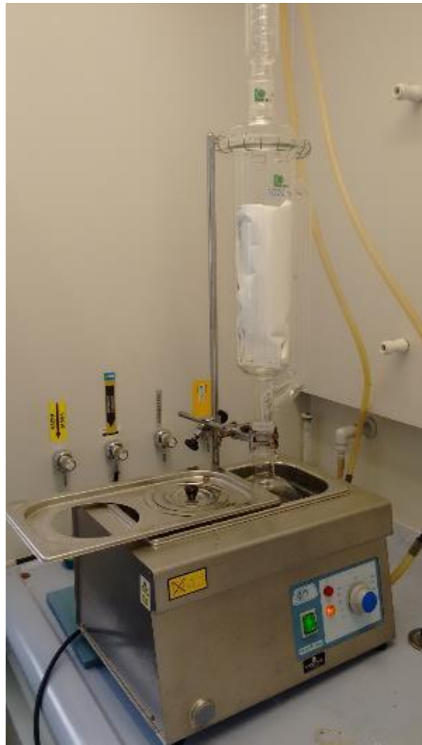
Figura 4.5 Procedimiento mediante extracción con soxhlet.
