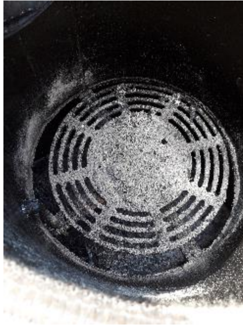
Figura 5.7 Tamiz giratorio cubierto de cenizas
