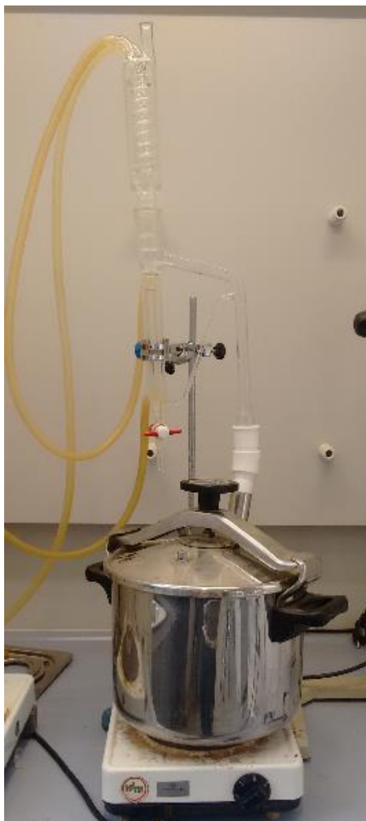
Figura 4.1 Proceso hidrodestilación poda del olivar
