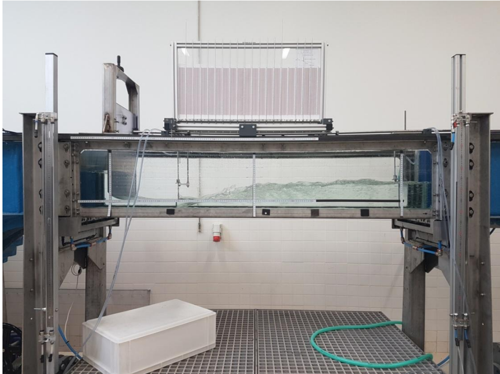
Figura 43: Ensayo compuerta laboratorio C.C.T. de Linares.
