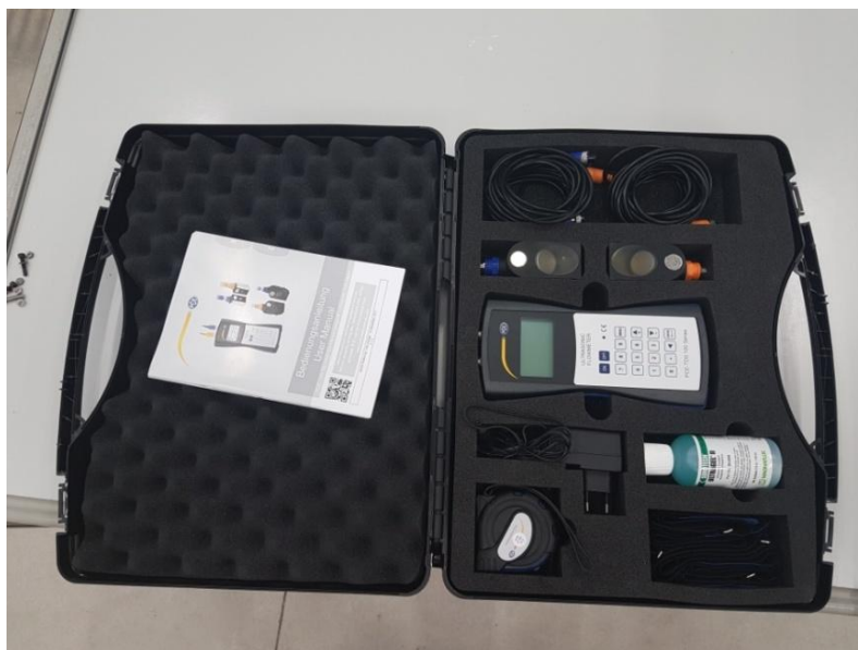
Figura 33: Instrumento de medición para el caudal.
