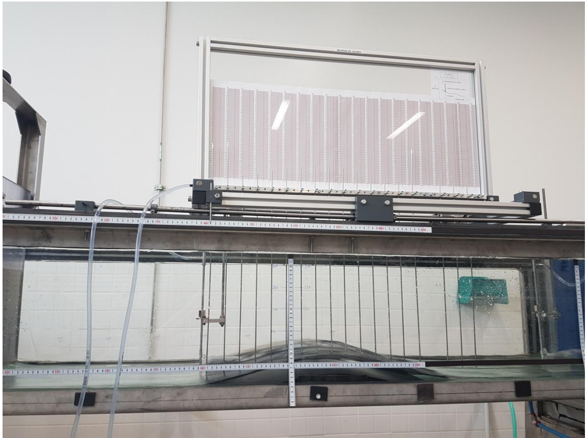
Figura 52: Transición de flujo Supercrítico a Supercrítico.
