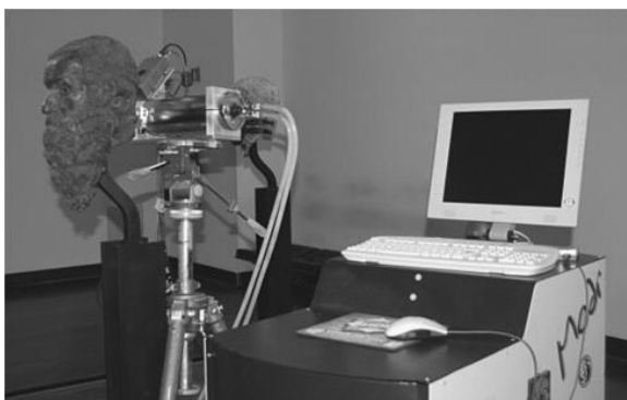
Figura 4.18. Instrumentos utilizados para las mediciones en los bronce de Porticello (el instrumento LIBS colocado a la derecha de la imagen, mientras que el XRF está en el trípode) (Ferretti et al. 2007).
