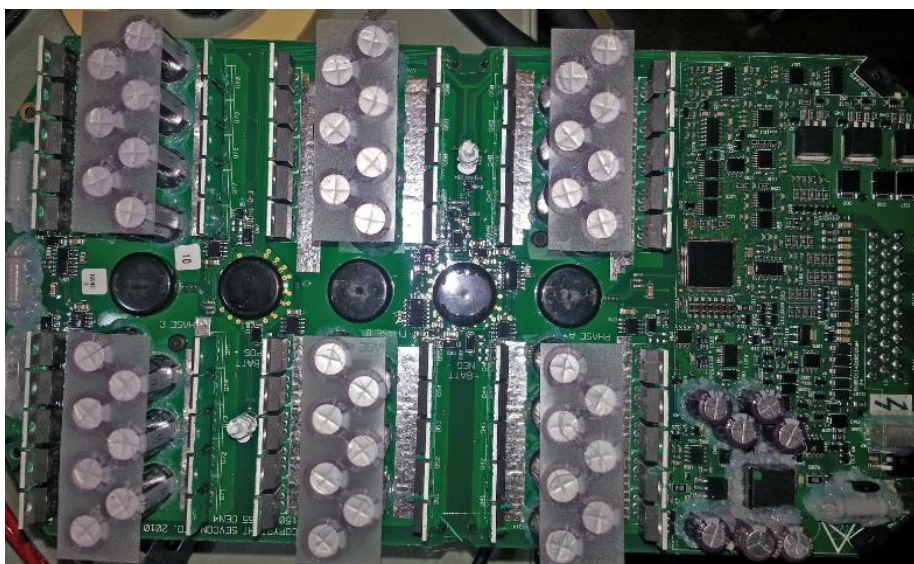
Ilustración 30 - Interior del controlador GEN6 de Sevcon. Se puede distinguir la zona izquierda el circuito de potencia y a la derecha el circuito de control. En la parte de potencia podemos distinguir los 10 mosfets en paralelo que trabajarán como uno solo, acompañado de 7 condensadores.
