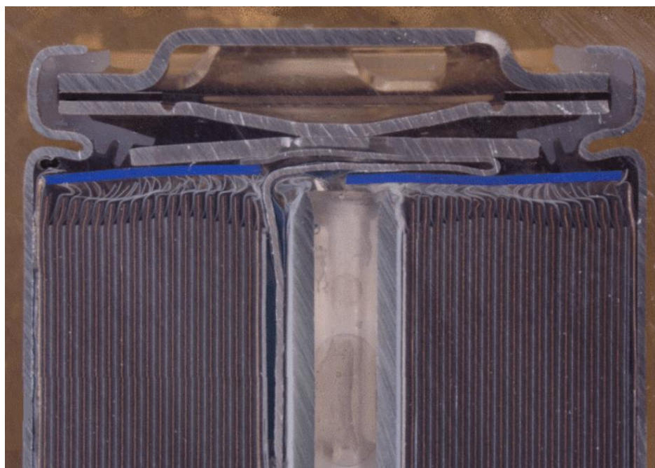
Ilustración 21 - Fotografías de construcción de la batería MOLICEL INR 18650. Superior izquierda corte transversal donde se observa el ánodo y cátodo. Superior derecha corte longitudinal con sistema de ventilación en caso de explosión. Inferior corte longitudinal de batería real.
