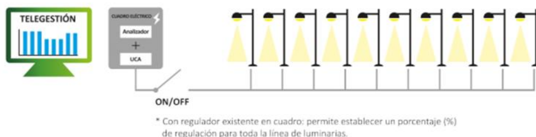
Ilustración 7: Esquema de un sistema de telegestión. Fuente: (Wellness Smart - cities & solutions)
