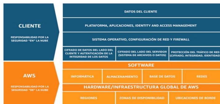
Ilustración 23 Modelo de responsabilidad compartida en torno a la seguridad de AWS
