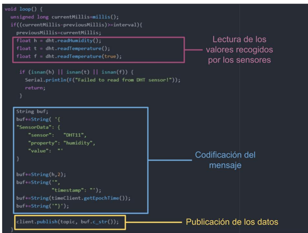
Figura 25. Lectura y publicación de datos por MQTT en placa NodeMCU ESP8266 con sensores integrados
