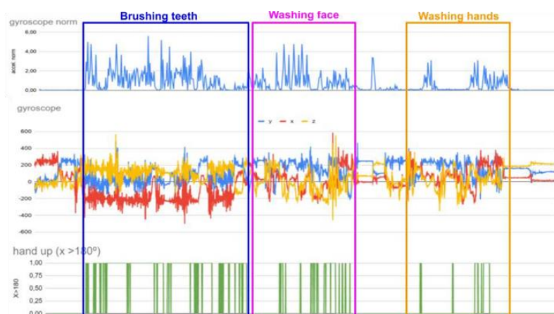
Figura 49. Cantidad de movimiento basada en la norma del giroscopio y detección de la elevación basada en la aceleración del eje X
