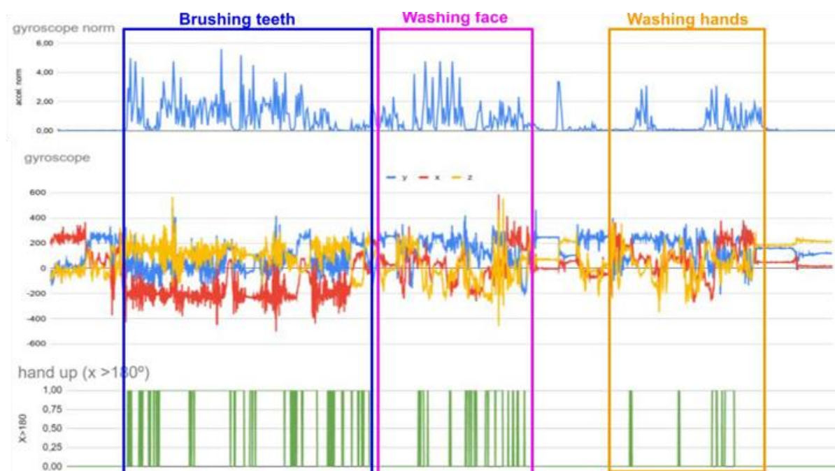
Figura 38. Arriba) Cantidad de movimiento basada en la norma del giroscopio), centro) valor de los componentes de los ejes X,Y,Z y abajo) detección de la elevación basada en el eje X>180°
