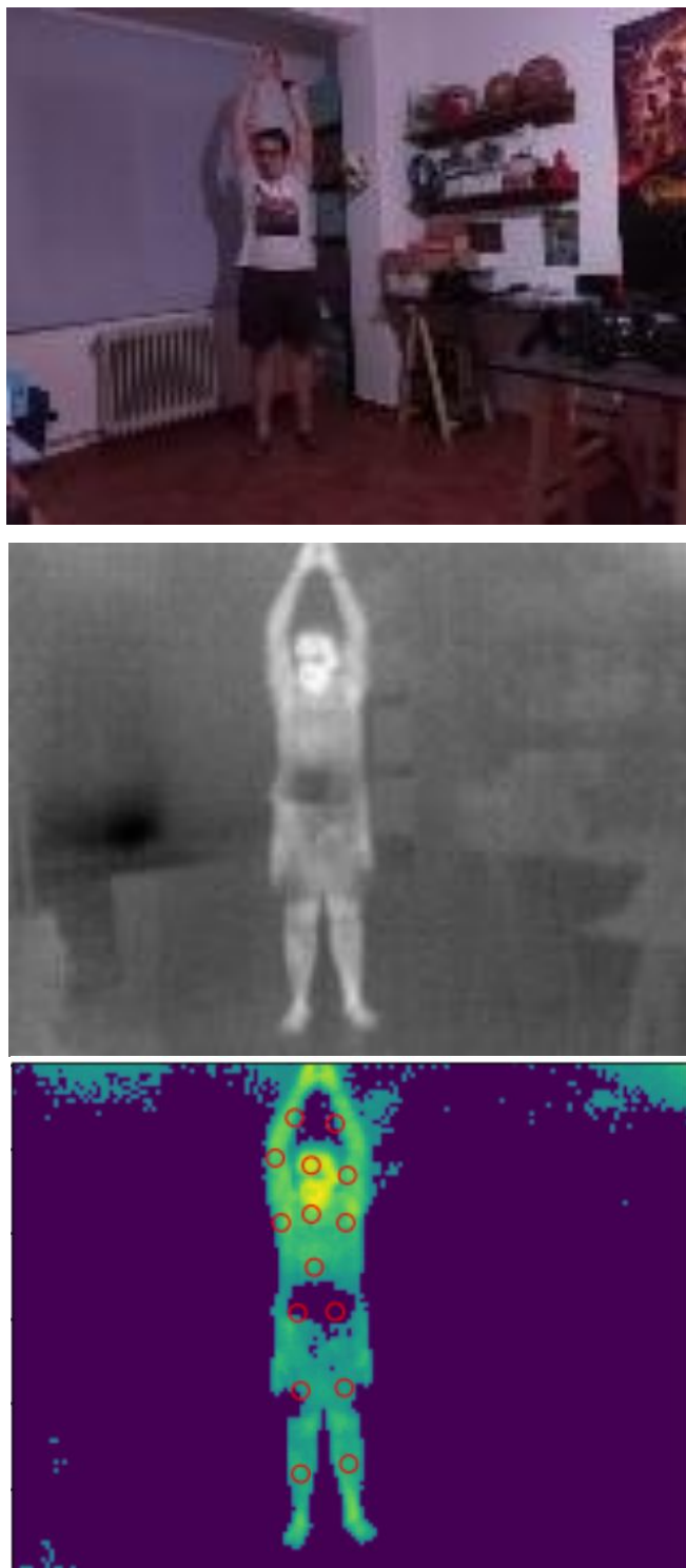
Figura 42. Imagen de espectro visible correlacionada con la imagen de espectro termal y los puntos de landmark de estimación de OpenPose en la termal en escala de calor
