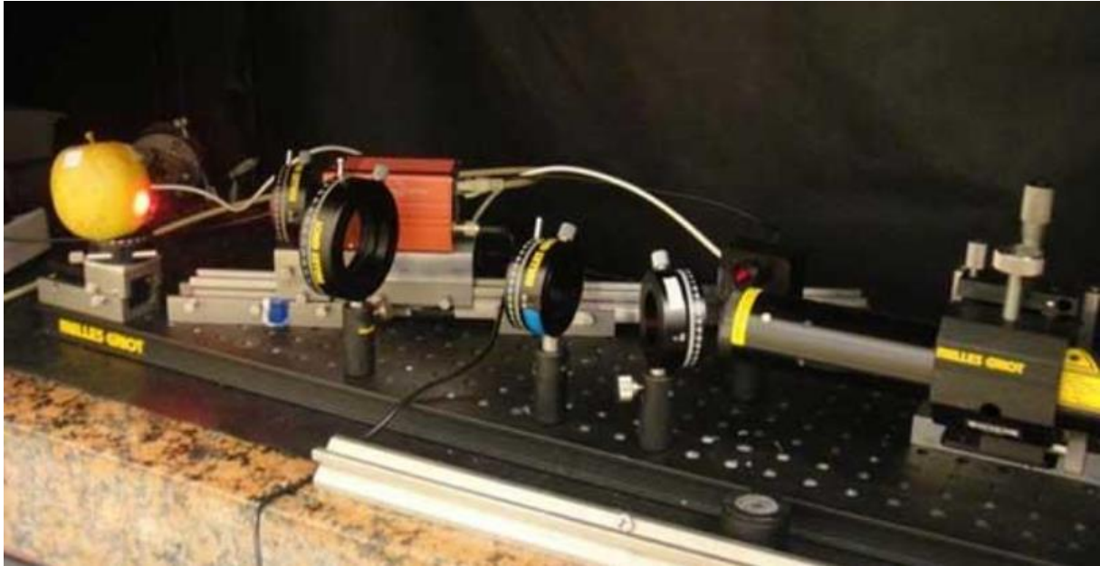
Ilustración 3: Técnica láser, comprobación de maduración de fruta
