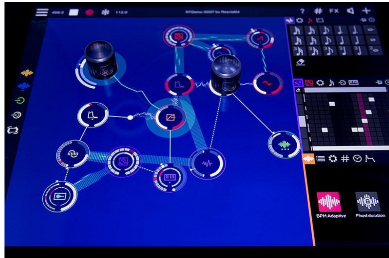
Figura 16: Funcionamiento e interfaz de Reactable
