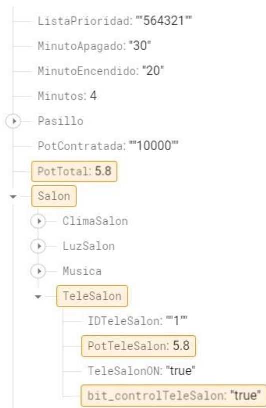
Ilustración 5.8. Activación del resto de variables y cálculo de la potencia de la tele en Firebase
