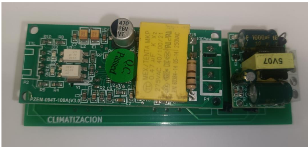
Ilustración 4.28. Cara A del módulo de climatización
