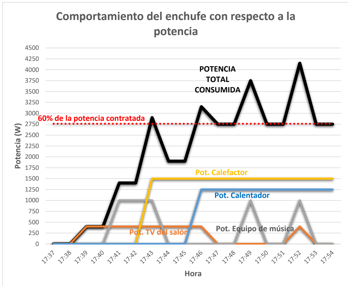
Ilustración 5.12. Gráfica del comportamiento de los enchufes con respecto a la potencia
