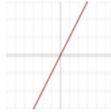
Figura 2.4: Función de activación lineal Laughsinthestocks [2015b]
