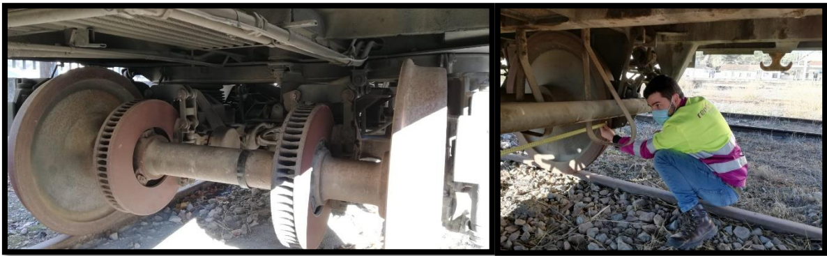
Figura 5: Izquierda: Eje montado de un bogie Gran Confort. Derecha: Autor del TFG realizando la medición del eje.
