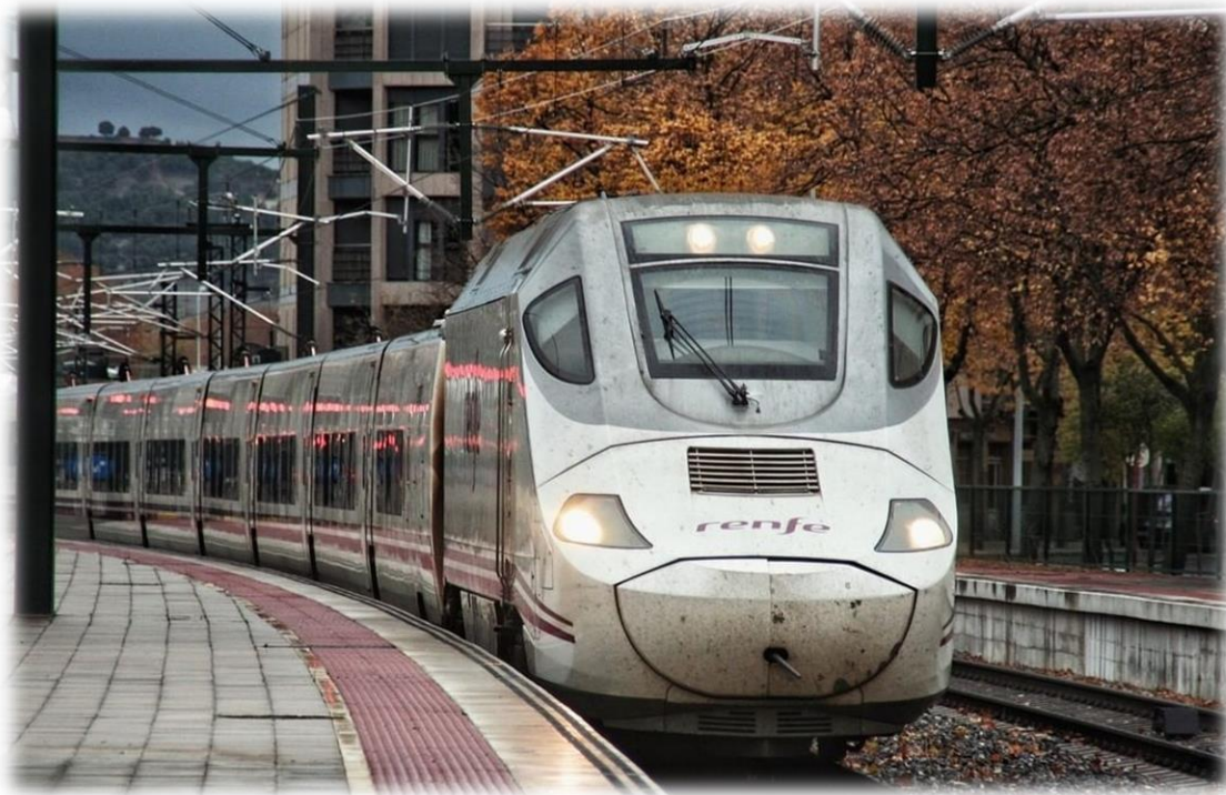
Figura 1: Tren de alta velocidad Renfe S-130 con ancho de vía variable
