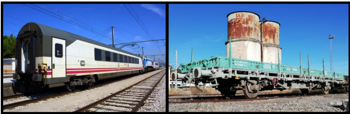
Figura 3: Izquierda: Coches serie 2.000 de Renfe conocidos como "Arco" Derecha: Plataforma Renfe de 2 ejes tipo MQ (serie internacional Kgs)
