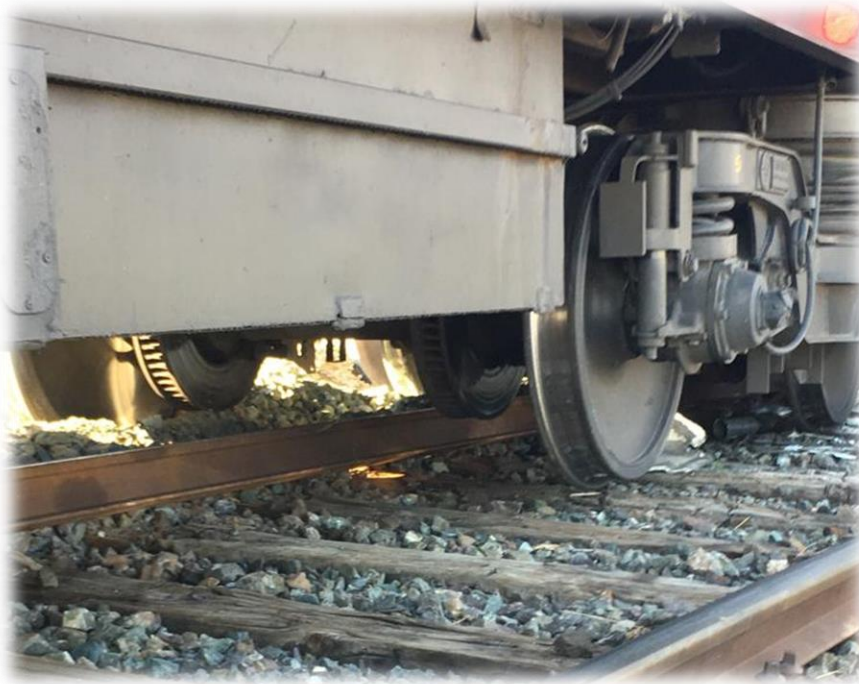
Figura 12: Fenómeno de descarrilo del tren
