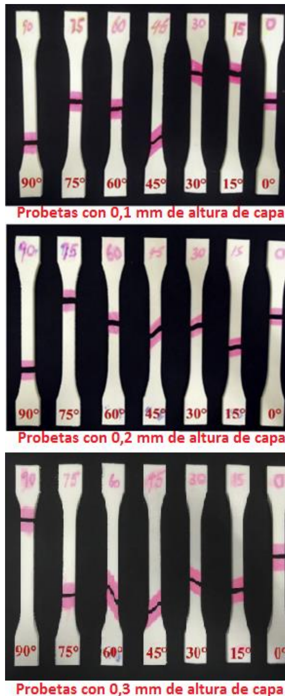
Ilustración 26: Distintas fracturas en las probetas del estudio de Yao et al. (2019).
