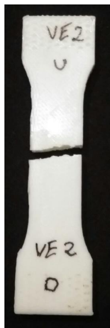
Ilustración 23: Fractura con comportamiento frágil en la probeta VE-2.
