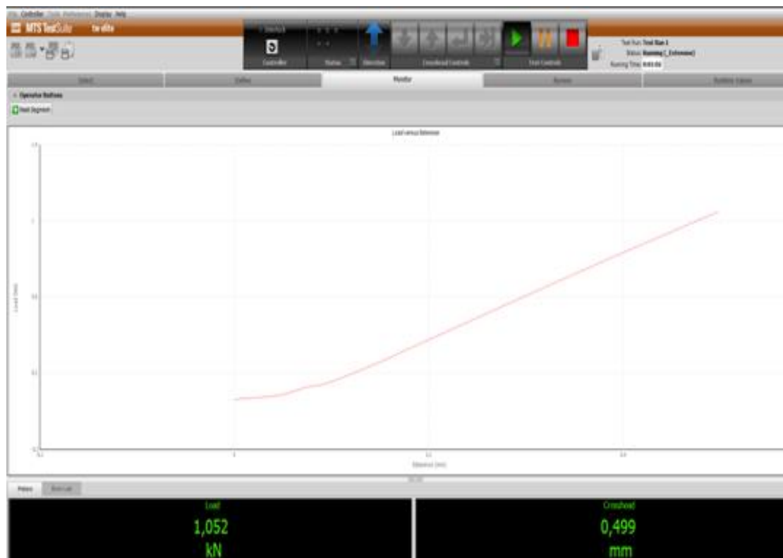
Ilustración 11: Entorno del software TW Elite durante un ensayo de tracción.
