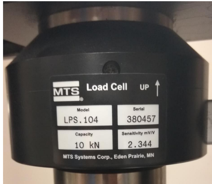
Ilustración 8: Célula de carga.
