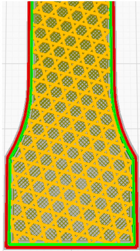
Ilustración 18: Probeta con patrón de relleno “tri-hexagonal”.
