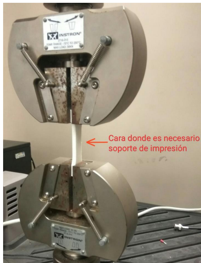
Ilustración 16: Posición de la pieza de canto para el ensayo de tracción. Ejemplo probeta RE-5C.
