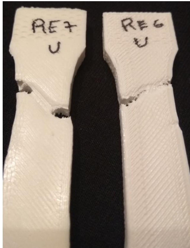
Ilustración 22: Fractura con comportamiento elástico en las probetas RE-7 y RE-6.
