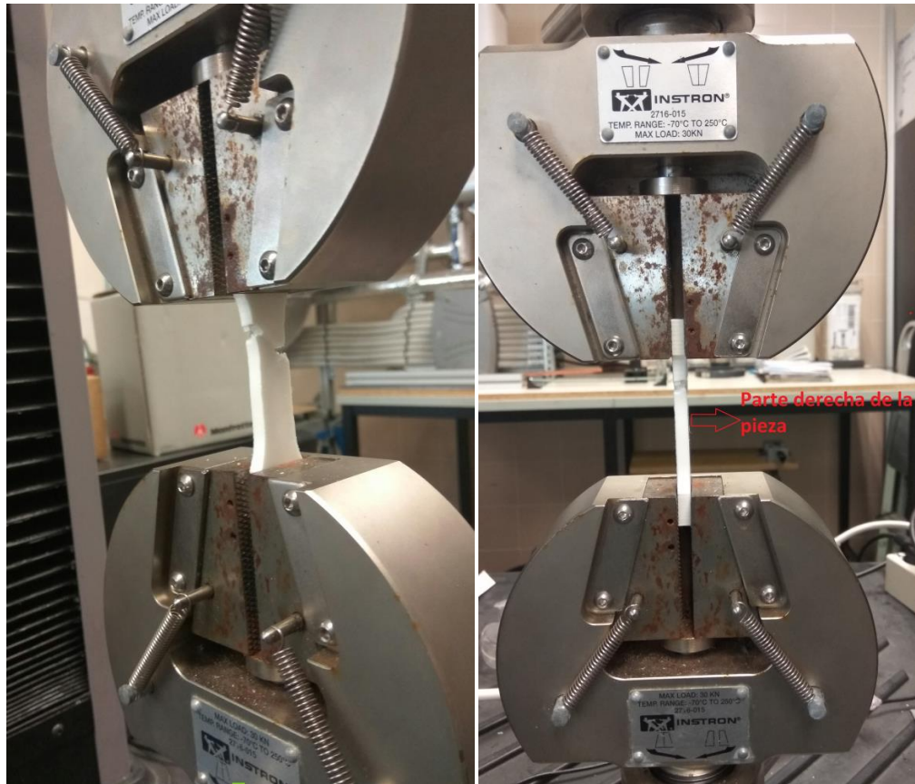
Ilustración 15: Posición de la pieza horizontal para el ensayo de tracción. Ejemplo probeta RE-7.
