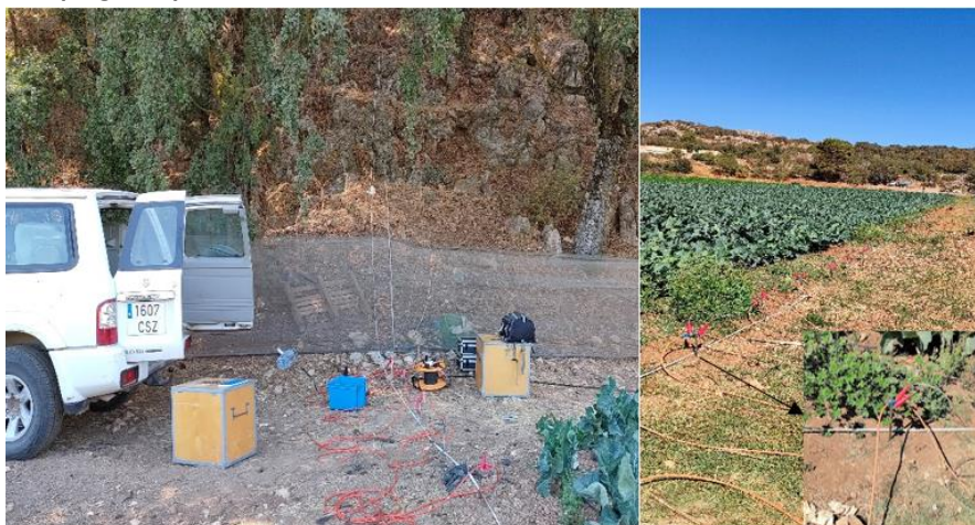
Figura 13: Modo de conexión y empleo de los electrodos para la adquisición de datos de resistividad de subsuelo.
