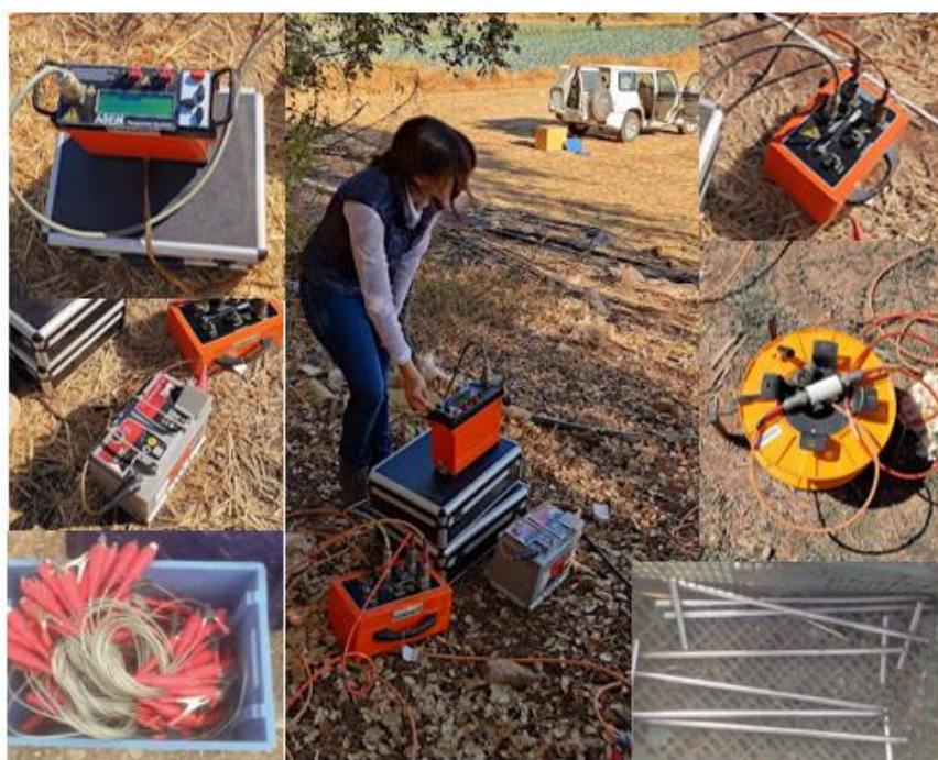
Figura 15: Equipo completo Abem Terrameter SAS4000. A- microcomputadora. B- caja de conexiones. C- conectores de bobinas de cable. D- electrodos. E- Conectores de cable con electrodos. F- Batería de 12 V.
