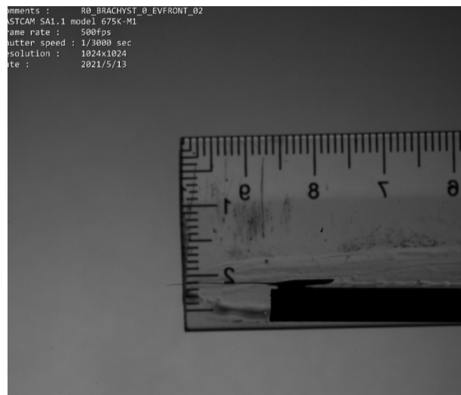
Figura 2.44. Foto tomada con la cámara de alta velocidad de la plataforma en el túnel de viento con una semilla de Brachypodium y en la que se aprecia la escala de medida.
