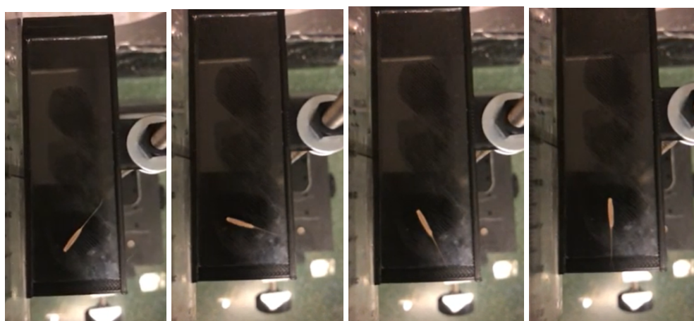
Figura 3.21. Brachypodium stacei con \beta = 135^\circ , la semilla se reorienta a \beta = 0^\circ . Vista superior de la plataforma. Entre las velocidades del viento de 1,6-1,8 m/s comienza a girar para ponerse en posición frontal y con 3,4 m/s consigue volar.
