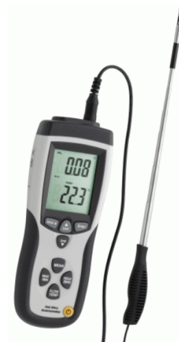
Figura 2.37. Anemómetro Dostmann TA 888 utilizado para la medición de la intensidad turbulenta
