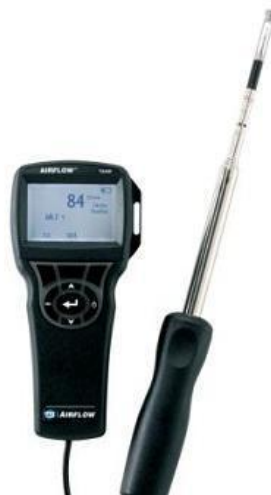
Figura 2.34. Anemómetro AIRFLOW TA430 utilizado en los ensayos
