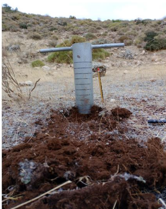
Figura 12- Ejemplo de extracción de suelo.
