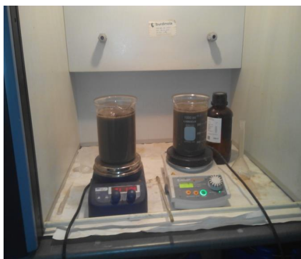
Figura 6. Proceso de lavado de las cenizas.
