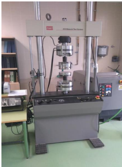
Figura 9. Máquina para ensayo de resistencia a compresión. MTS 810. Material Test System.
