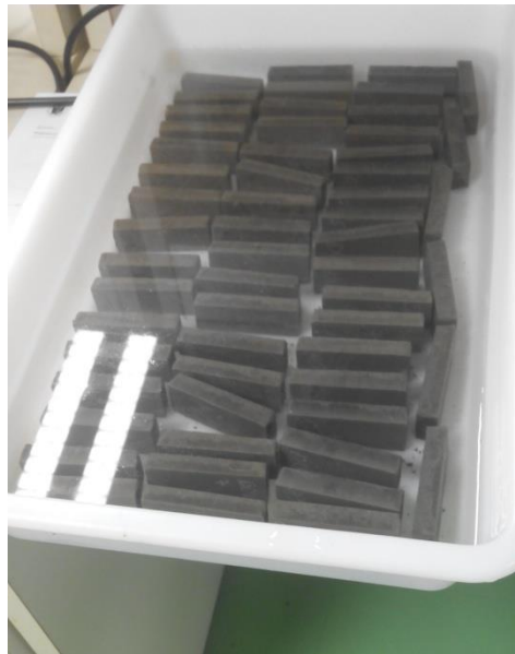
Figura 8. Proceso de curado de las muestras en agua durante 28 días.
