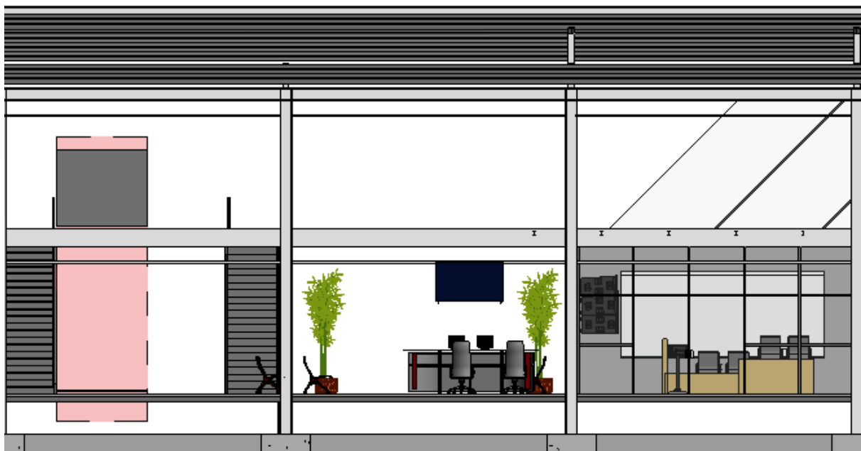
‘Figura 100. Vista tras la colocación del ascensor’
