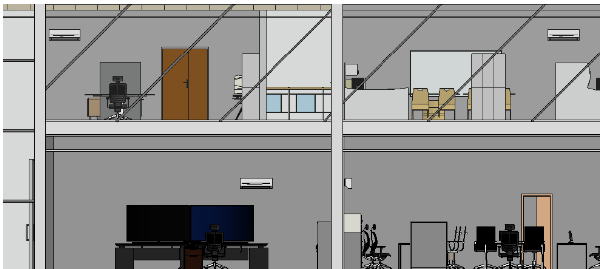
'Figura 138. Vista de despachos superiores y las oficinas tras el modelado de los aire acondicionados'
