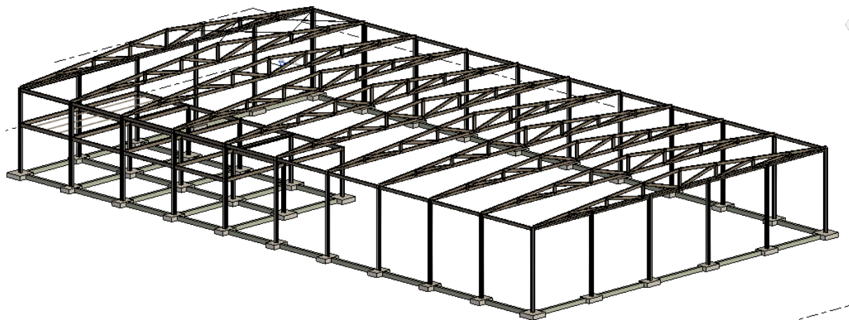
‘Figura 31. Vista 3D tras la colocación de la celosía’
