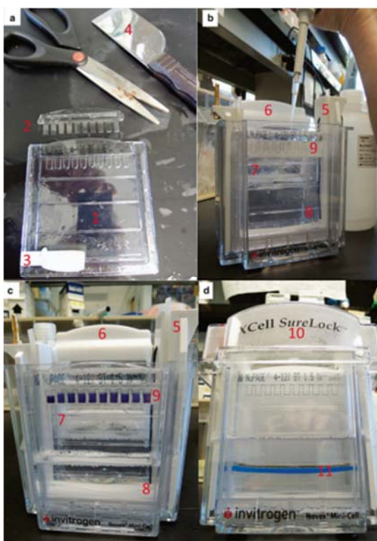
Fig.15: Configuración de electroforesis en gel de poliacrilamida (PAGE). (a) Se extrae cuidadosamente el peine de la parte superior del gel prefabricado. (b) Se monta el tanque para crear un depósito ajustado superior e inferior, se sujeta y se llenan los depósitos con el tampón de funcionamiento. (c) Se cargan las muestras que contengan colorante indicador en los pozos. (d) Se pone la tapa, se enciende la fuente de alimentación y se controla el progreso mediante la visualización del tinte indicador (Hnasko and Hnasko, 2015).
