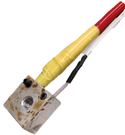
Figura 9.2. Cartucho metálico con resistencia calefactora y termopar
