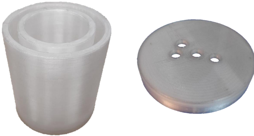
Figura 8.6. Recipiente y tapa impresos en PETG
