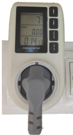
Figura 7.1. Medidor eléctrico de consumo
