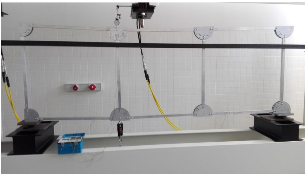
Figura 5.39: Viga Vierendeel con 80 kg de carga.
