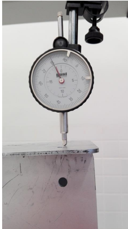
Figuras 5.65: a) Medida de desplazamiento sin carga. b) Medida de desplazamiento 50 kg.
