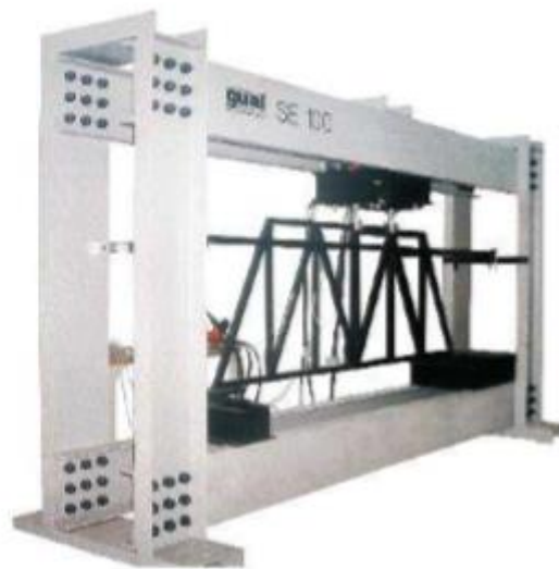
Figura 4.1: Imagen del bastidor Universal de ensayos GUNT SE 100. [1]
