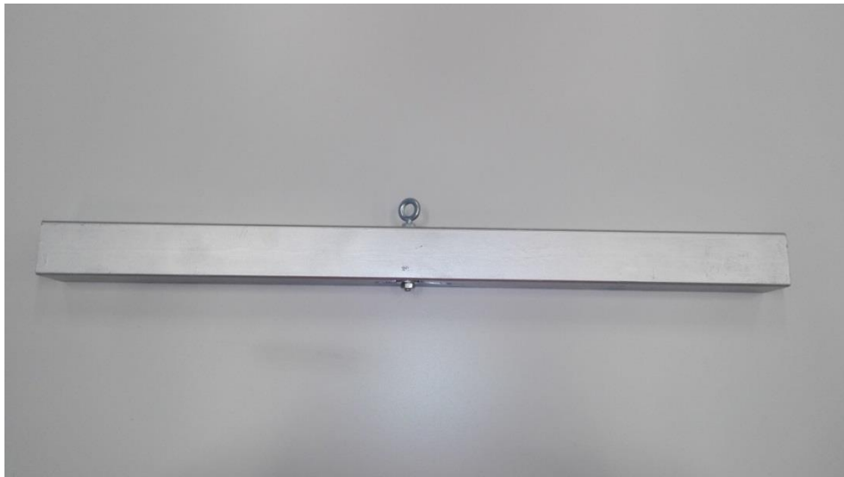
Figura 4.5: Soporte inferior del sistema de carga.
