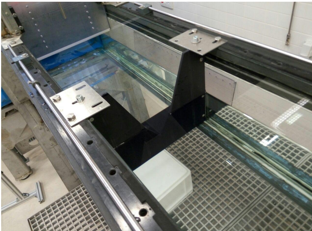
Ilustración 22: Vertedero triangular colocado en el área de ensayo
