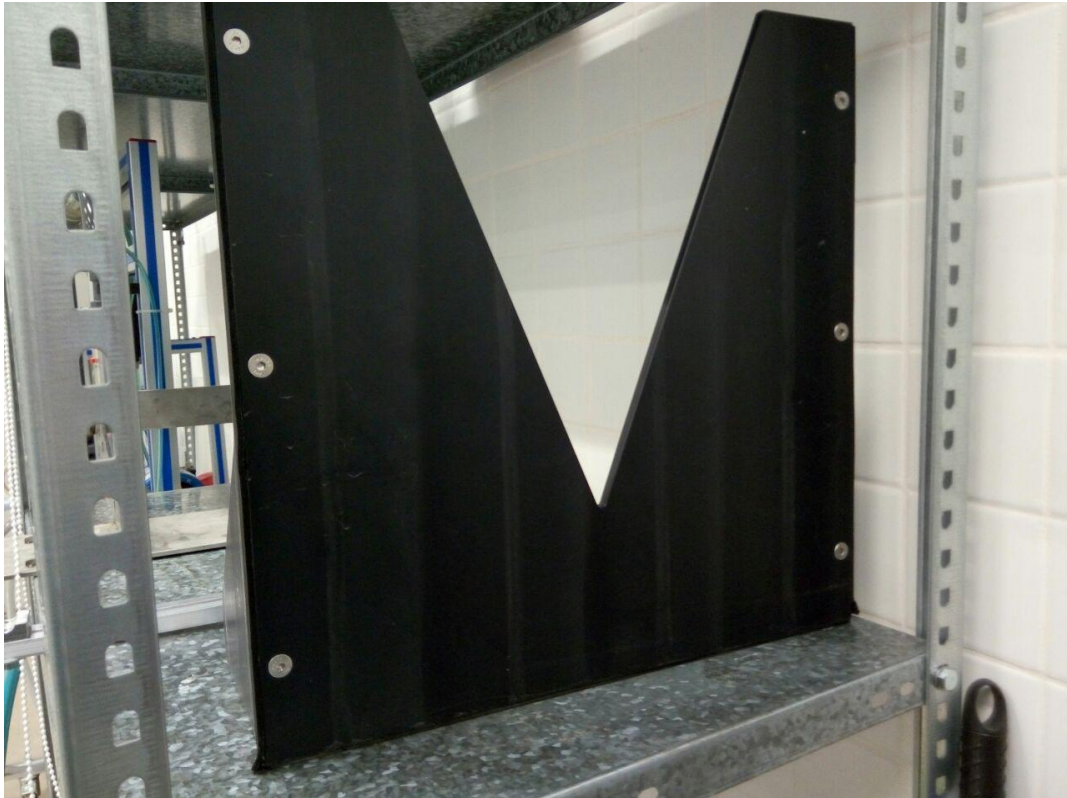
Ilustración 21: Vertedero de pared fina con escotadura triangular disponible en el laboratorio
