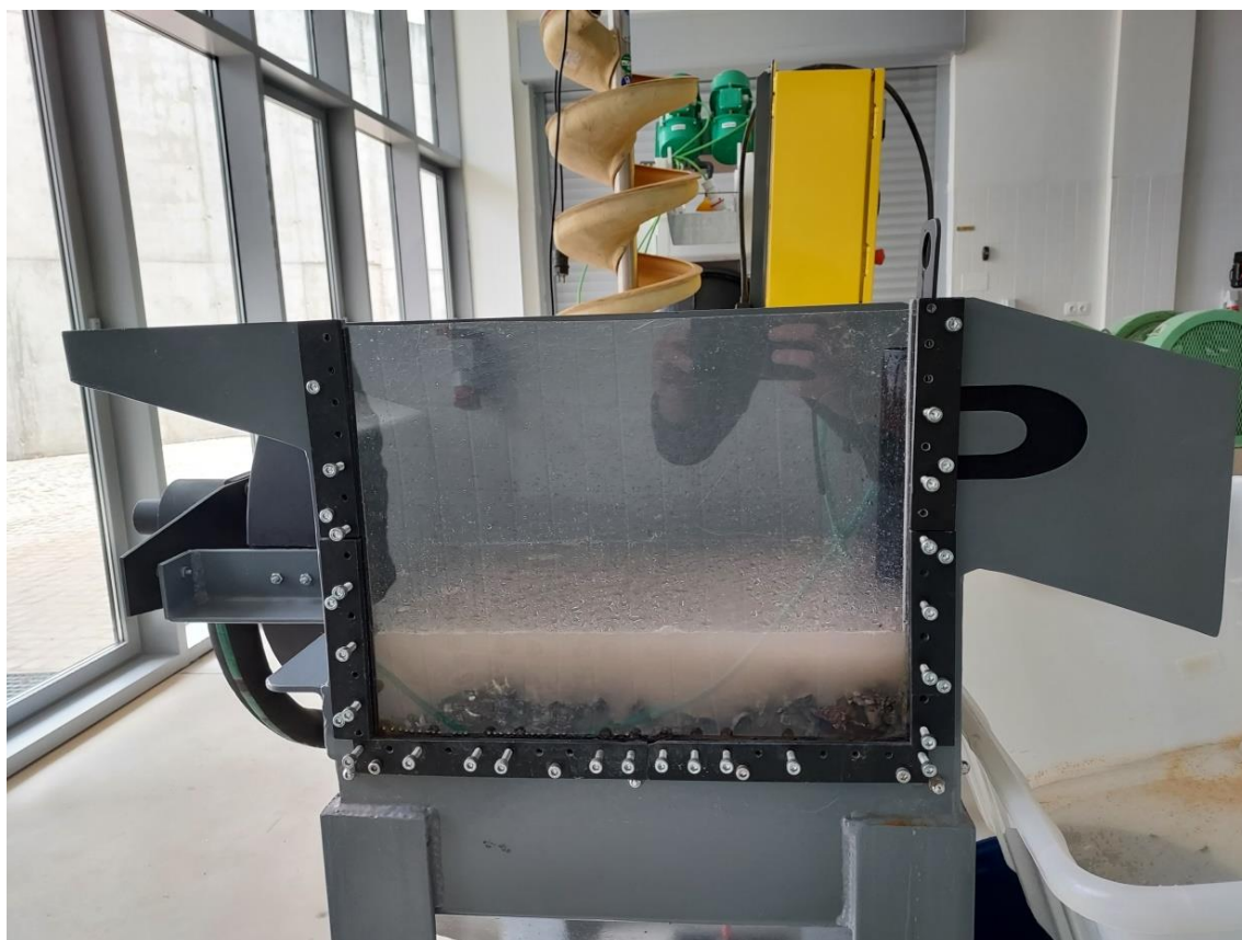
Figura 8.11 Jigs Denver de presa y compuerta
