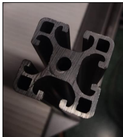
Ilustración 41: Perfil de aluminio de ranurado en T. Elaboración propia.
