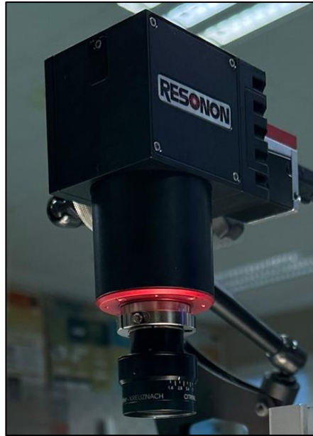
Ilustración 2: Cámara hiperespectral Pika L. Elaboración propia.
