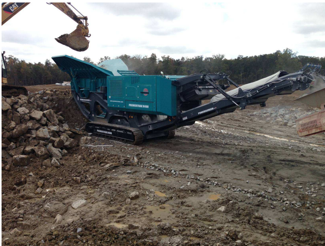
Foto 12: Trituradora móvil de mandíbulas Powerscreen Premiertrak R400
