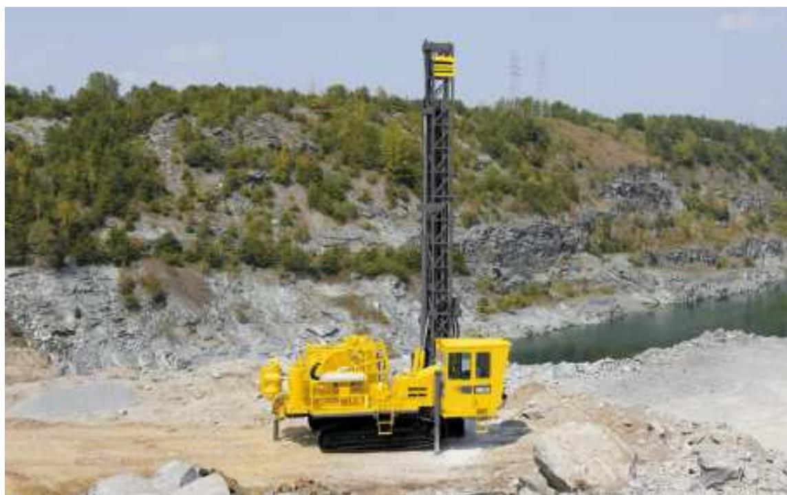
Foto 10: Perforación rotativa o con martillo en fondo - Atlas Copco DM30
