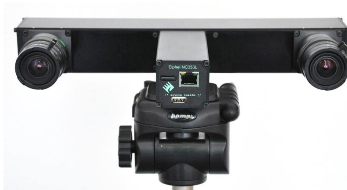
Ilustración 5.1 - Ejemplo de configuración de cámaras estéreo. Fuente: [36]
