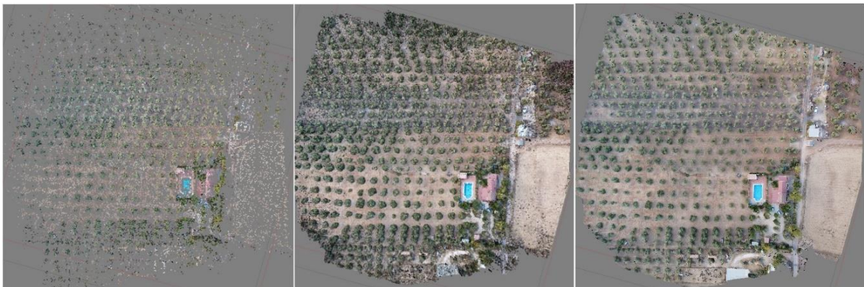
Ilustración 5.22 - Resultados en forma de nube de puntos dispersa (izquierda), nube de puntos densa (centro) y modelo con textura (derecha) de la ejecución con parámetros de calidad muy alta sobre el conjunto de imágenes de Torrecillas, vistos desde arriba. Fuente: Elaboración propia.
