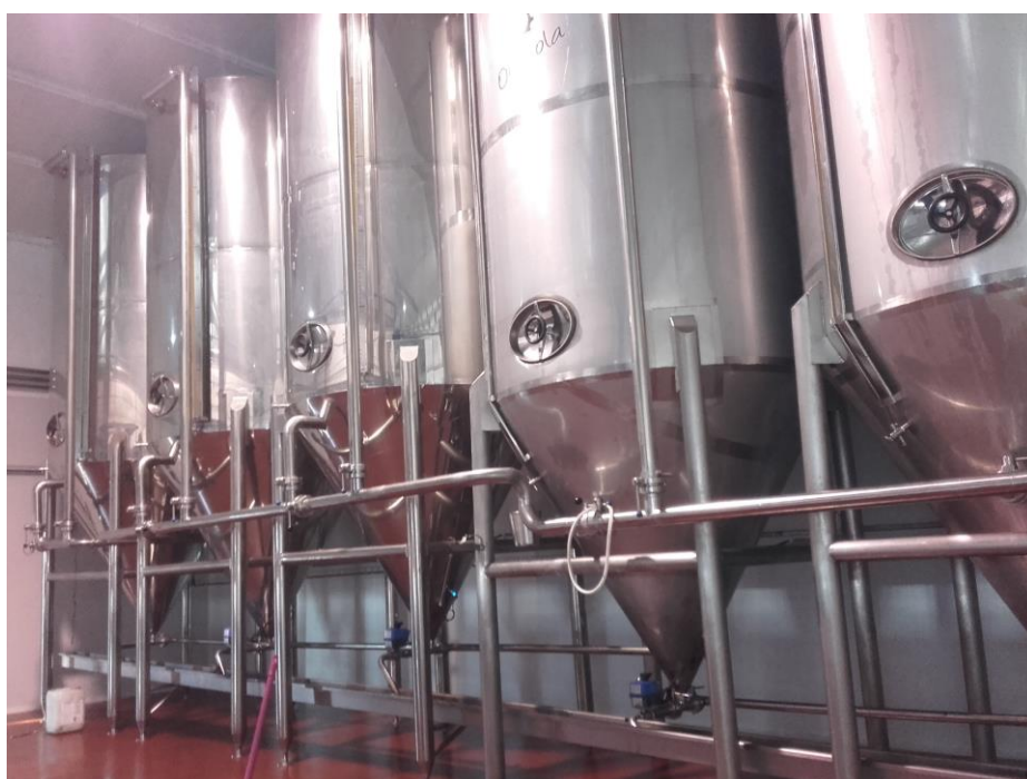
Fig. 4.3.2.4. Depósitos de decantación. Fuente: Elaboración Propia.
