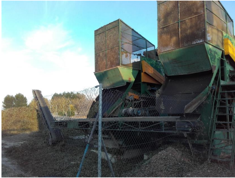
Fig. 4.3.2.1.- Líneas de limpieza-lavado de aceituna. Fuente: Elaboración propia.
