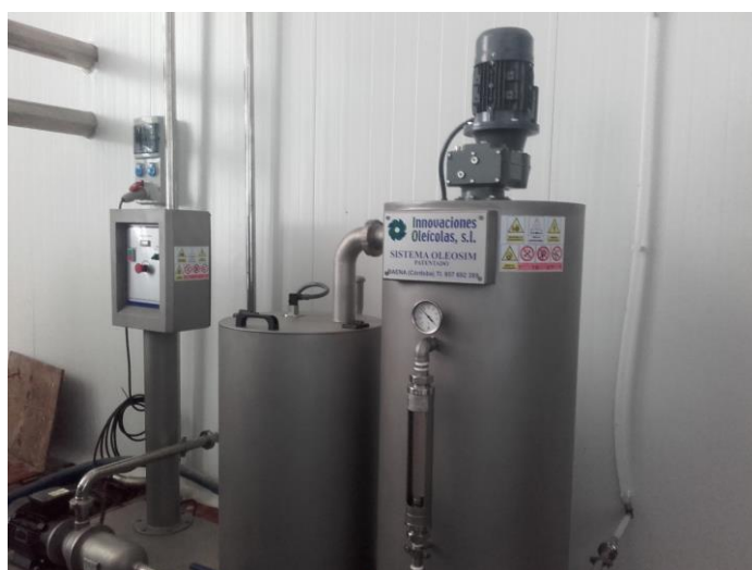
Fig. 4.3.2.3. Sistema de lavado de aceite OLEOSIM®. Fuente: Elaboración Propia.
