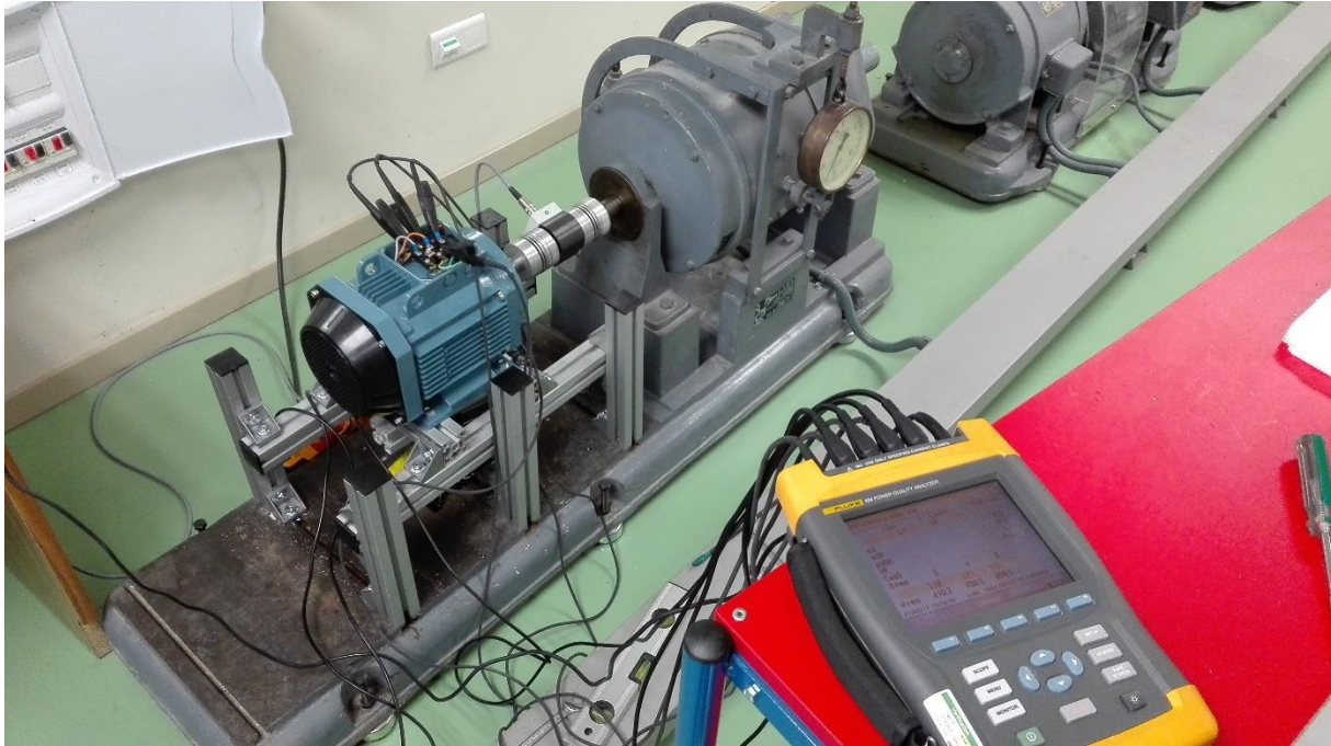
Ilustración 30 Imagen del primer tipo de conexión de los aparatos de medida
