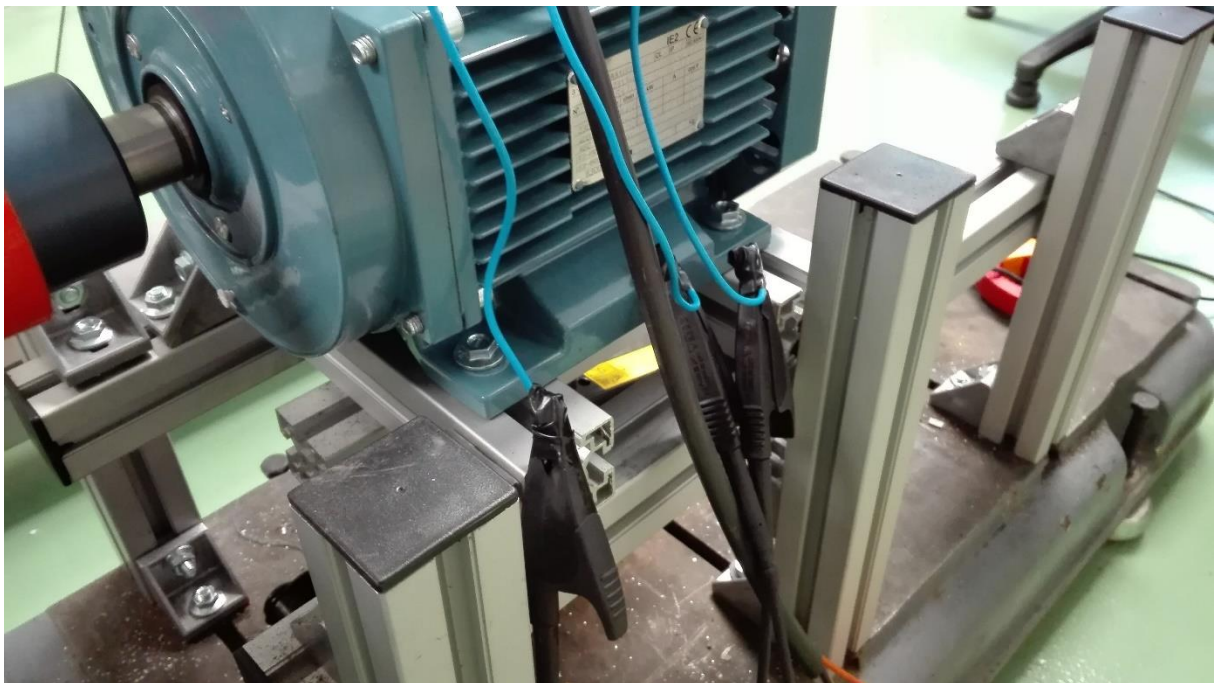
Ilustración 26 Detalle de las pinzas correctamente conectadas
