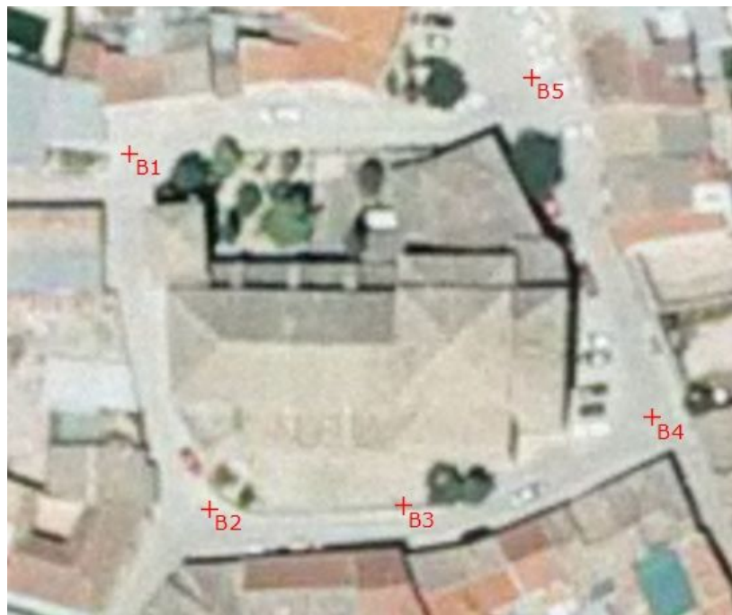
Figura 4.3: Bases topográficas para realización de levantamiento topográfico medidas con GPS.
