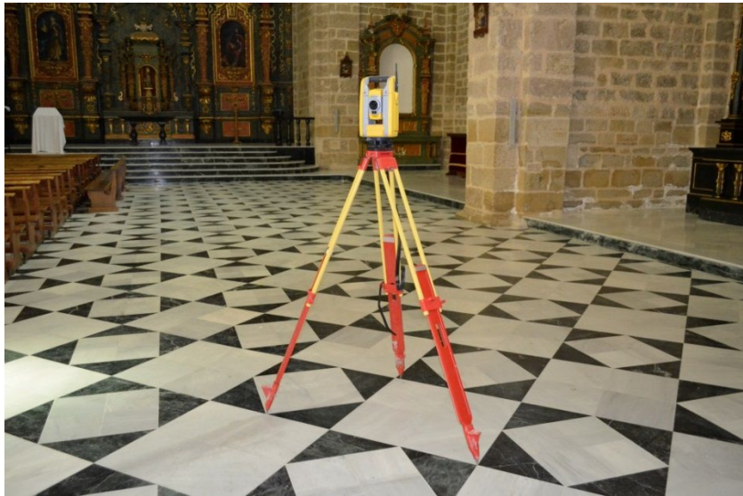
Figura 4.2: Estación total Trimble S3 en estacionamiento libre.
