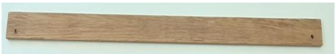
Ilustración 45: Trozos madera con los agujeros en 11mm x 2mm
