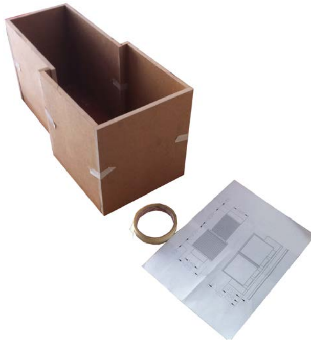
Figura 80. Fabricación de molde en madera DM de 12 mm.
