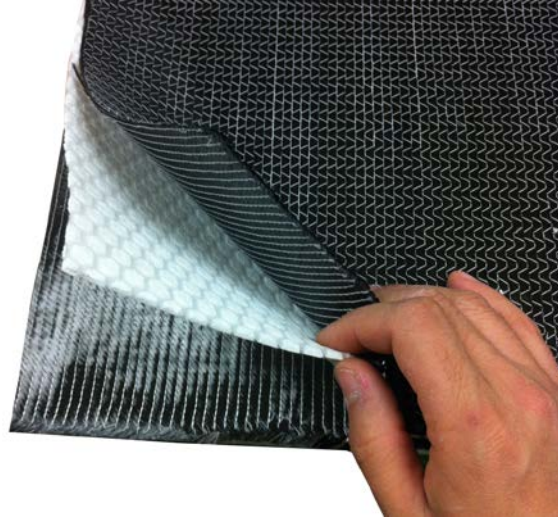
Figura 84. Colocación de distintas capas de fibra de carbono y núcleo.
