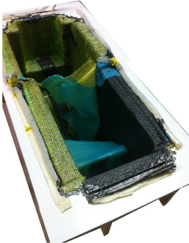
Figura 99. Proceso de desmoldado.
