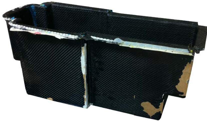
Figura 101. Contenedor de fibra de carbono tras su desmoldado.
