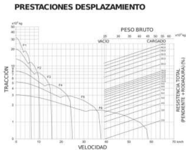
Gráfica 2. Prestaciones desplazamiento volquete HM300-5.
