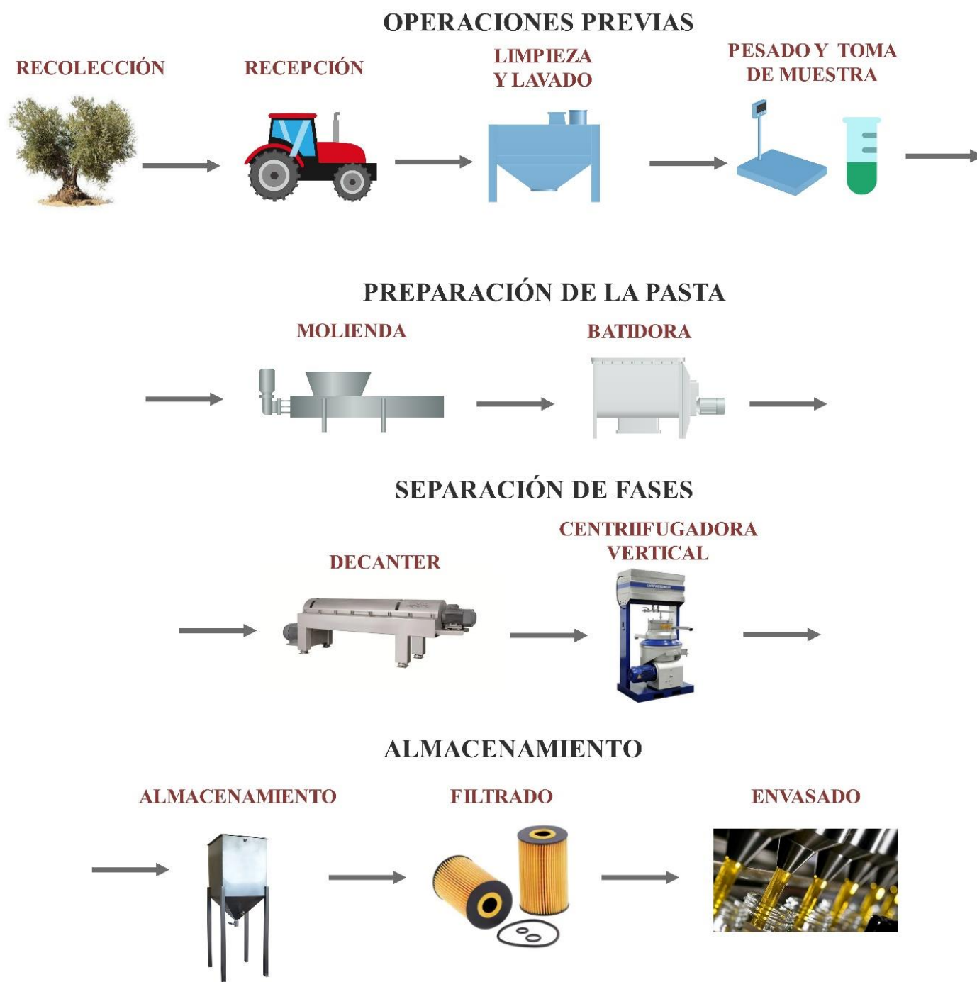
Figura 4.1 Etapas del proceso de producción del aceite de oliva.
