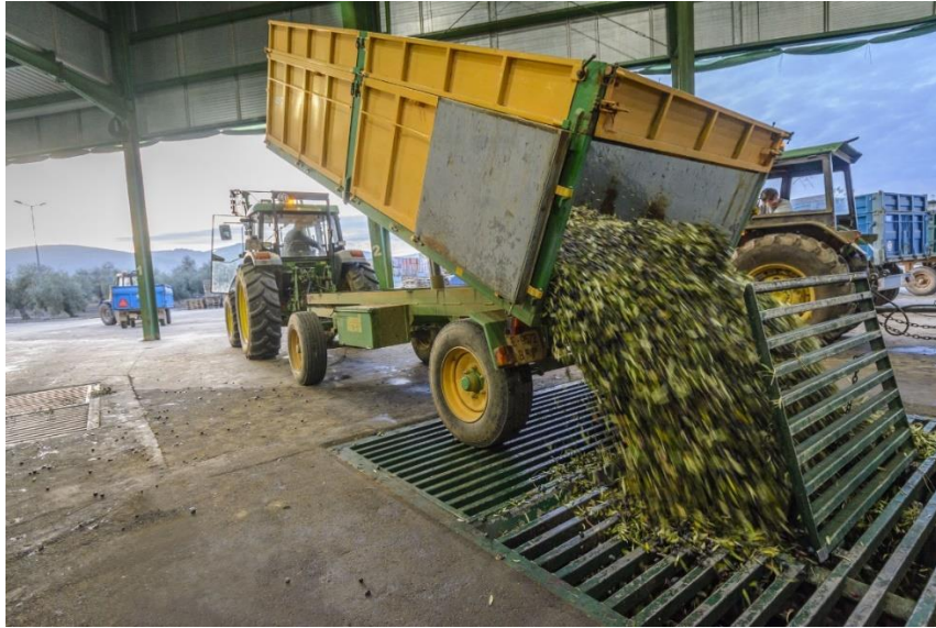
Figura 4.3 Recepción de aceituna en almazara.
