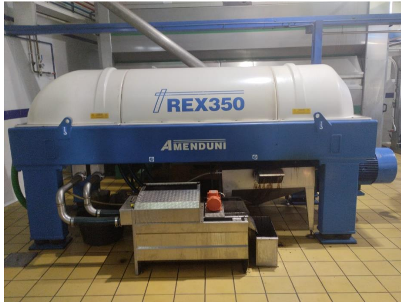
Figura 4.8 Decanter instalado en la almazara “Olior Porcuna”
