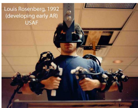
Figura 2.5 – Sistema de AR Virtual Fixtures
