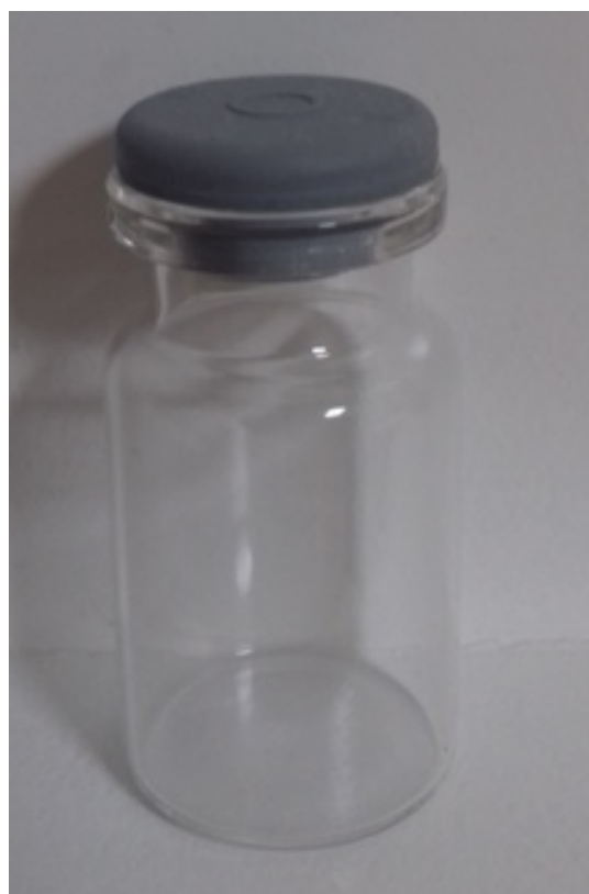
Ilustración 30. Vial sin Cápsula (No aceptado) [Fuente: Elaboración propia]
