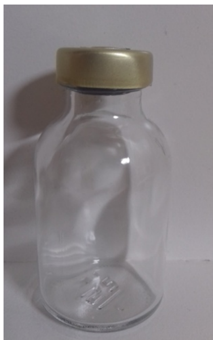
Ilustración 29. Vial mal cerrado (No aceptado) [Fuente: Elaboración propia]
