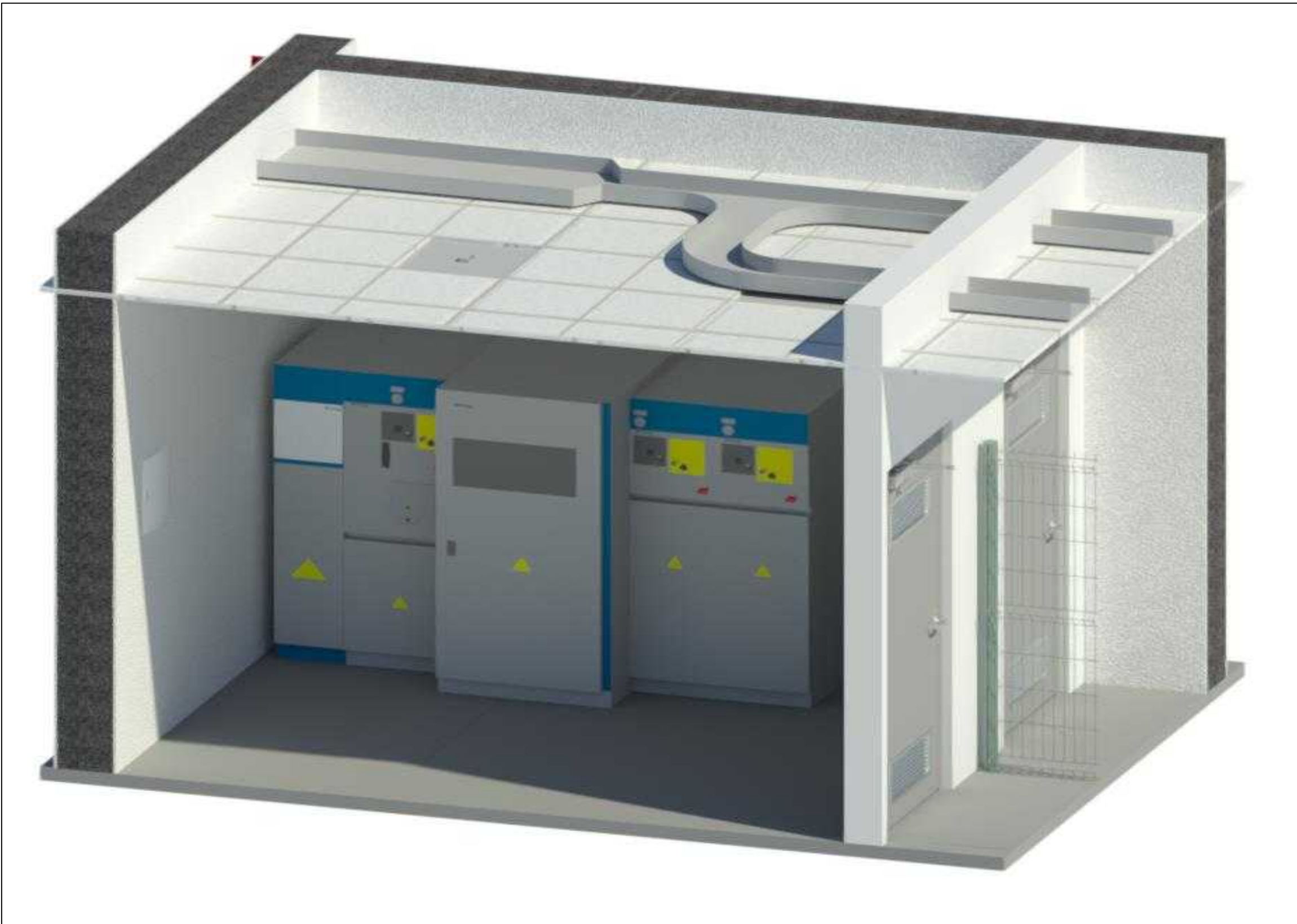
VISTA DETALLE DE LAS CELDAS DE REMONTE, MEDIDA Y PROTECCIÓN.
